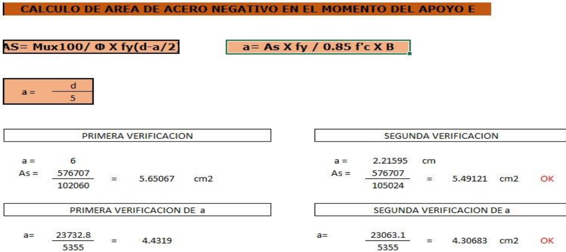
Figura 53: Cálculo de área de acero negativo en el apoyo E
