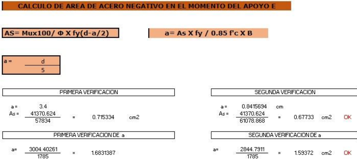
Figura 83: Cálculo de acero negativo en el apoyo E
