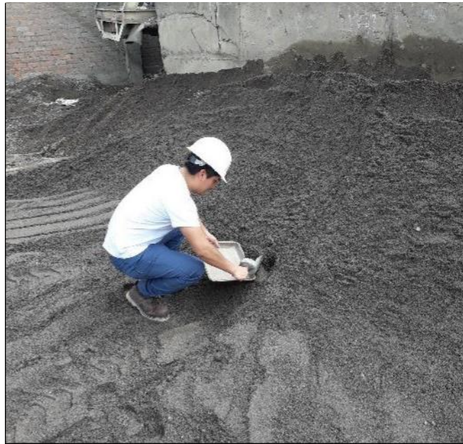
Gráfico 4 Toma de muestra del agregado fino de la cantera Mitapampa.
