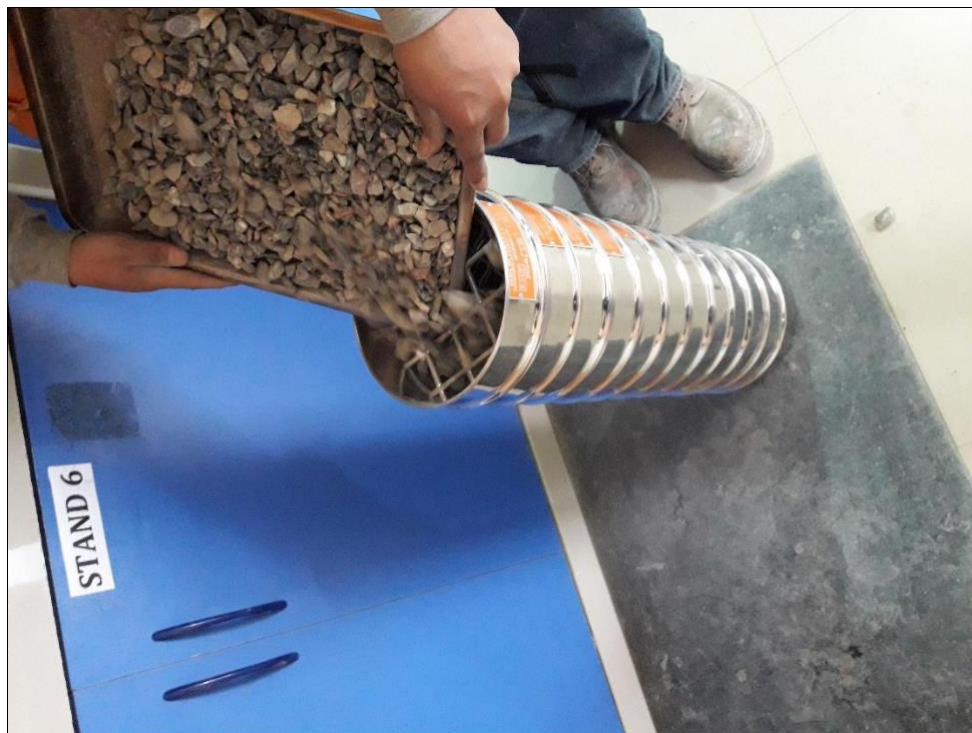
Gráfico 7 Tamizado de agregados
