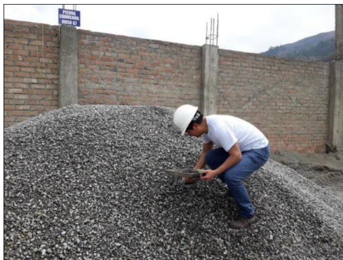
Gráfico 5 Toma de muestras del agregado grueso
