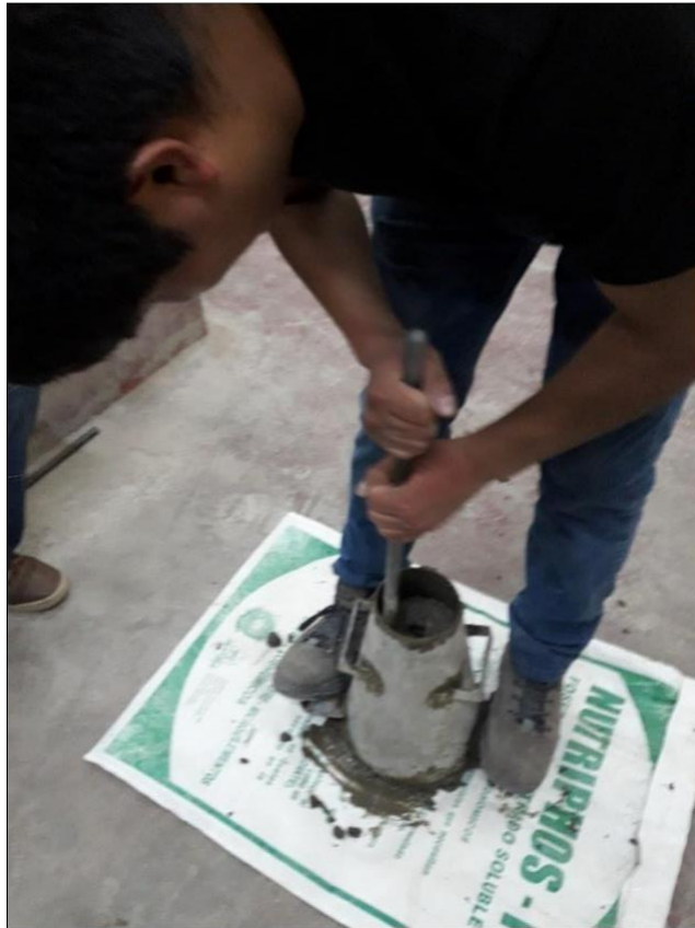
Gráfico 17 Prueba de Slump.
