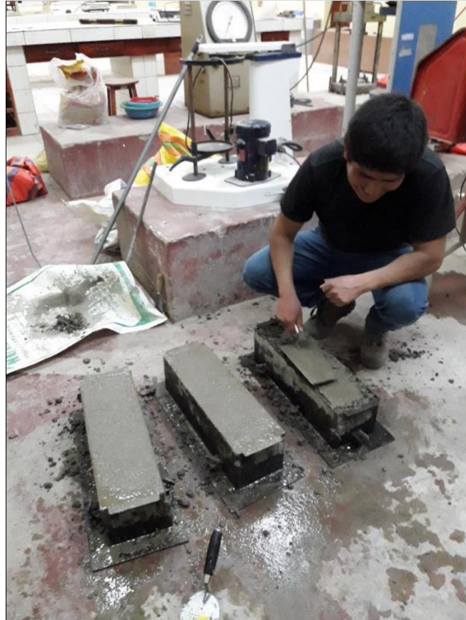
Gráfico 18 Vigas de concreto.
