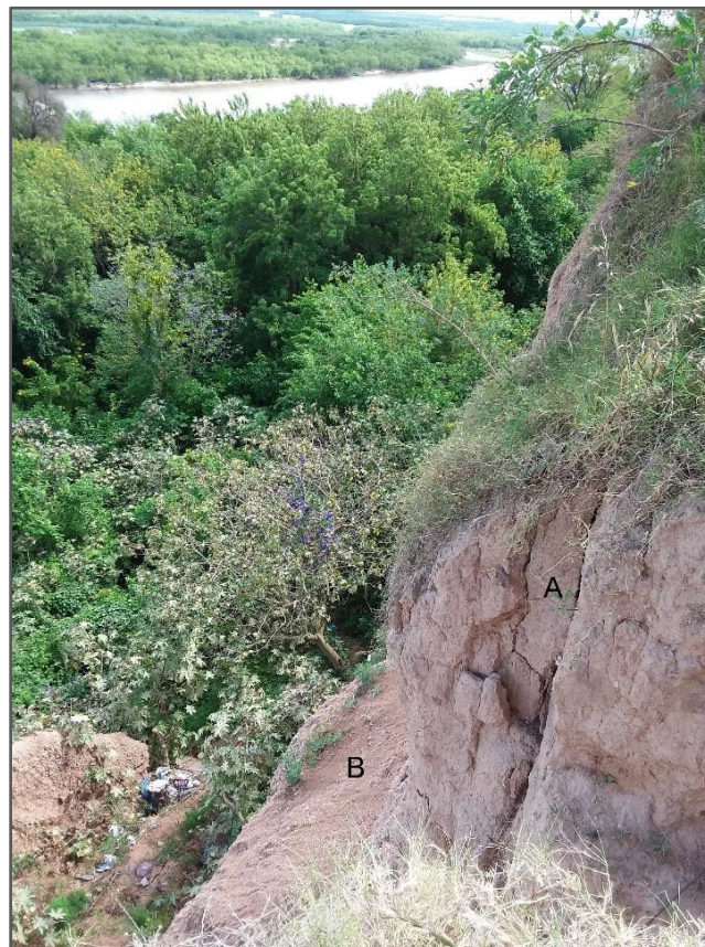
Figura 21. Bloque superior de la barranca compuesto por loess. (A) Grietas de tracción. (B) Pequeño escalón en la barranca, que evidencia el mayor retroceso y erodabilidad del loess superior. Borde de barranca en el barrio Urquiza.
