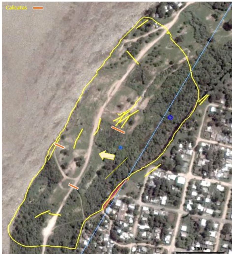
Figura 4. Vista de la zona movilizada en los suelos del pie de barranca, donde se han señalado las principales grietas de extensión, la dirección principal de desplazamiento y la ubicación de las calicatas.
