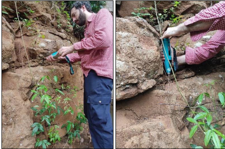
Figura A1.13. Medidas de resistencia mediante esclerómetro de Schmidt marca Proceq, modelo RockSchmidt tipo L.
