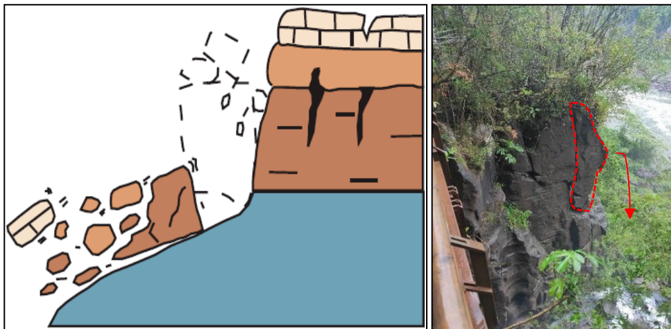
Figura 11. Representación esquemática del proceso de vuelco de bloques. Derecha: Bloque con potencial de desarrollar caída por vuelco en el sector del Salto Alvar Núñez.
