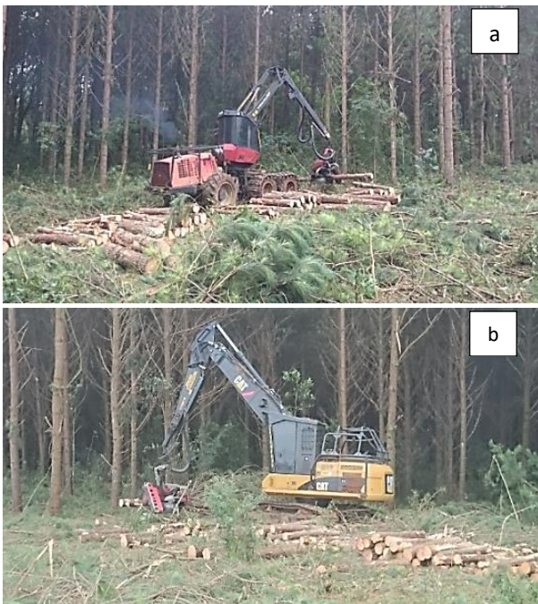
Figura 1. Máquinas avaliadas para as atividades de corte em povoamentos de Pinus taeda : (a) harvester de pneus e (b) escavadeira hidráulica adaptada.
