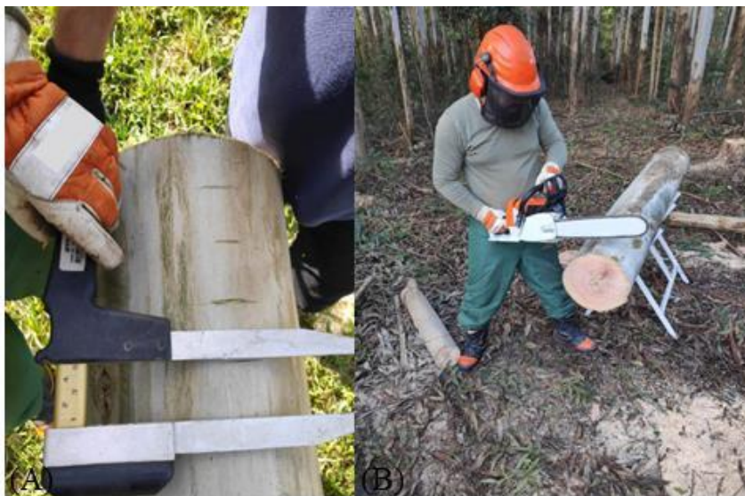
Figure 1. Marking the thickness of each disc (A); sectioning the discs and collecting hand-arm vibration data (B). Figura 1. Marcação da espessura de cada disco (A); seccionamento dos discos e coleta dos dados de vibração de mãos e braços (B).
