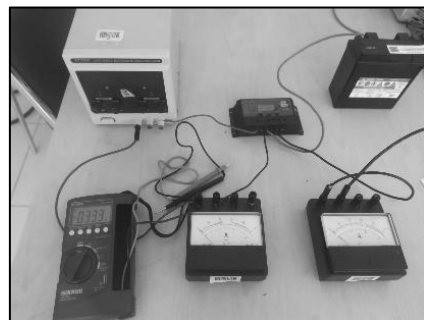
Gambar 5. Penyusunan komponen pengujian efisiensi SCC PWM.
