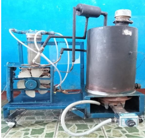
Gambar 1. Alat pirolisis pengolahan sampah
