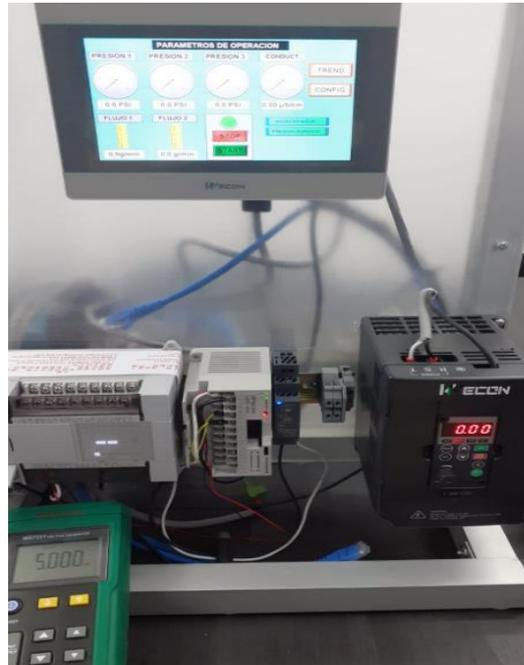
Figura 104. PLC interactuando con el HMI
