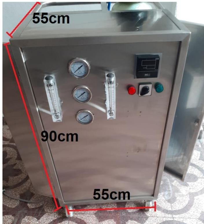
Figura 41. Chasis del equipo de osmosis portátil inversa
