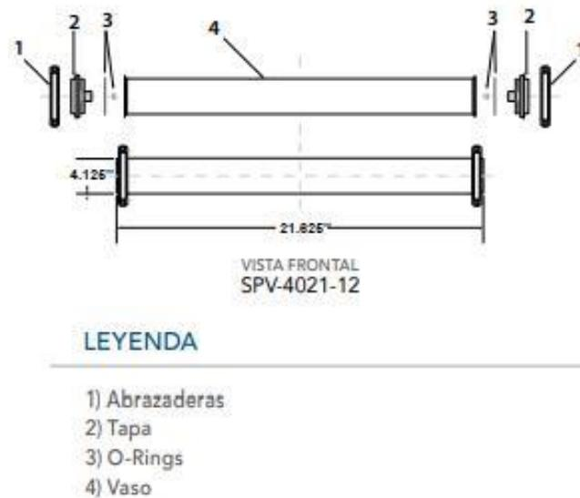
Figura 25. Dimensiones y partes de la porta membrana SPV-4021-12
