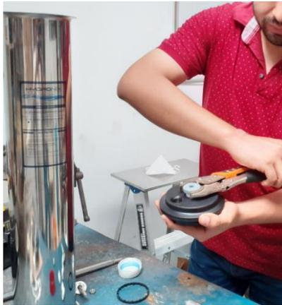
Figura 51. Ajuste de la tapa de la membrana
