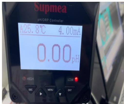
Figura 99. Simulación de la pantalla del sensor pH
