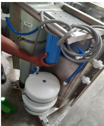
Figura 52. Colocación de los filtros de carbón y sedimento
