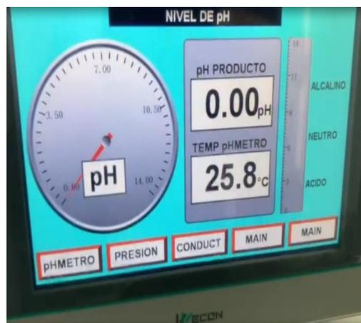
Figura 100. Simulación de la pantalla HMI en valor inicial
