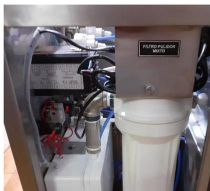
Figura 57. Filtro de pulidor mixto terminado
