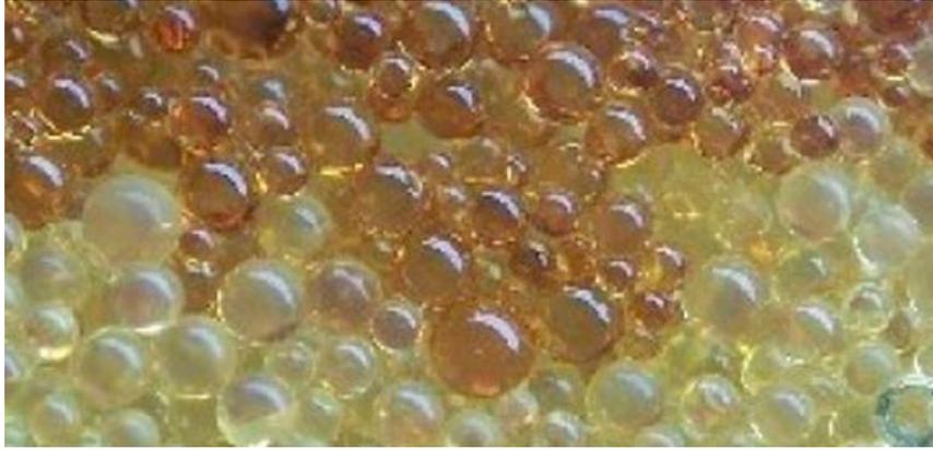
Figura 27. Intercambio iónico catiónica y aniónica
