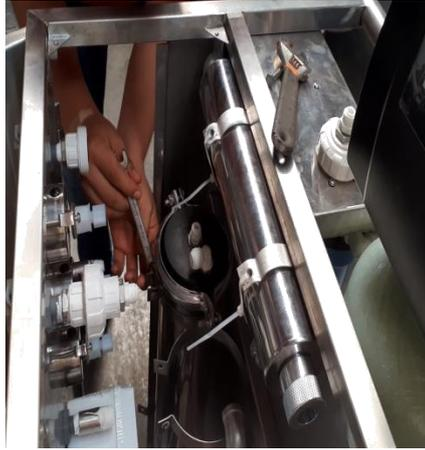
Figura 53. Membrana puesta en el Chasis
