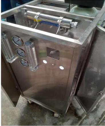
Figura 50. Manómetros y flujómetros empotrados
