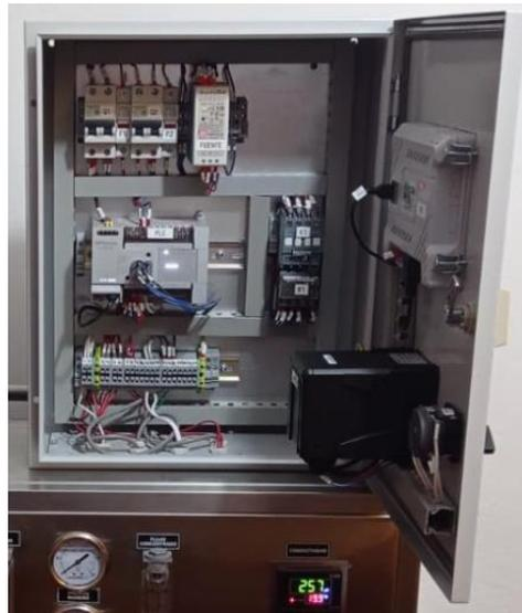
Figura 96. Equipo PLC terminado parte frontal
