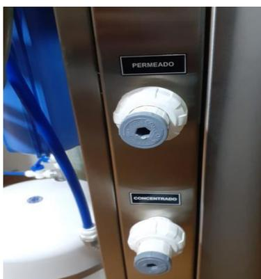
Figura 60. Salida lateral del permeado y concentrado terminado
