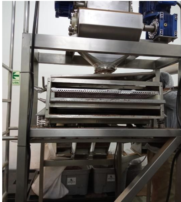
Figura 59:Compuerta para desmontaje de mallas
