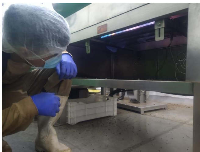
Figura 56: Inspección de chispero con máquina en funcionamiento
