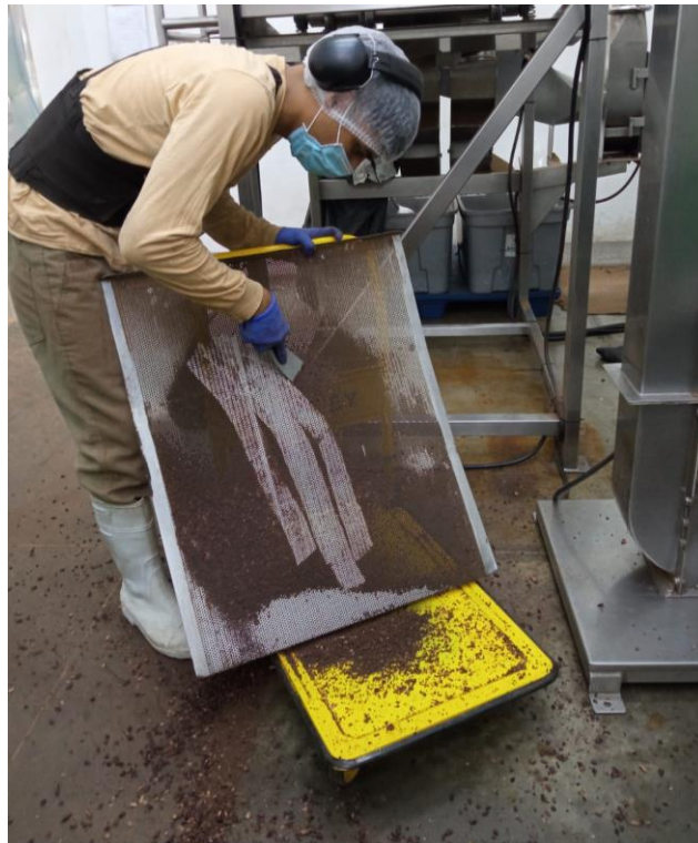
Figura 50: Limpieza de malla
