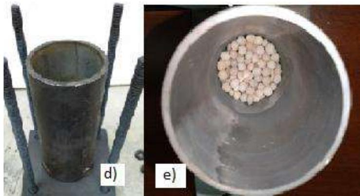
**Figura. 15-3:** Ensamble del cilindro y colocación de la preforma
