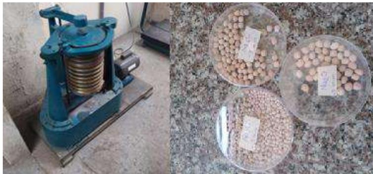
**Figura. 13-3:** Tamizado y envasado del óxido de sodio
