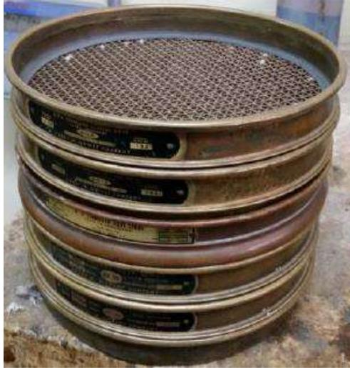
**Figura. 8-3:** Tamices ordenados según diámetro de poro
