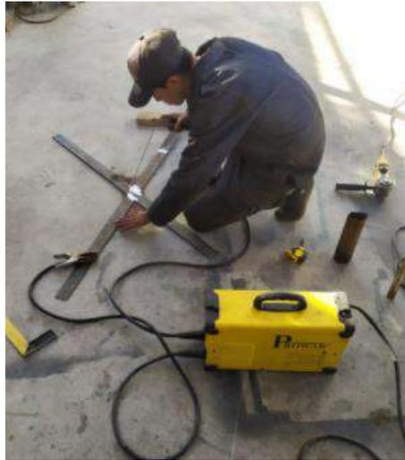
**Figura. 32-4:** Construcción de acople para sujetar la probeta
