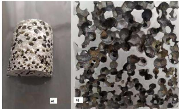
**Figura. 8-4:** Espuma de celda abierta a) Seccionada b) Pulida
