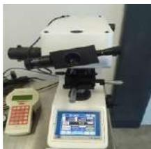
**Figura. 7-4:** Micro-durómetro Future-Tech
