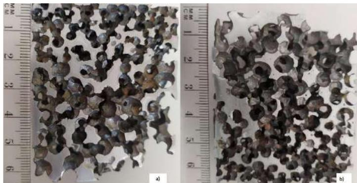
**Figura. 9-4:** Probeta a) y b) para medición de tamaño de poro
