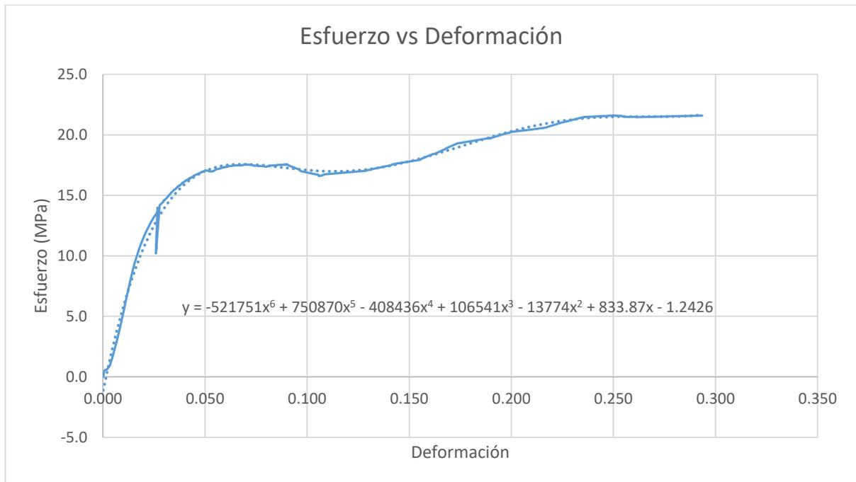
**Figura. 27-4:** Gráfico esfuerzo-deformación de la probeta EC-01-2 sujeta a compresión
