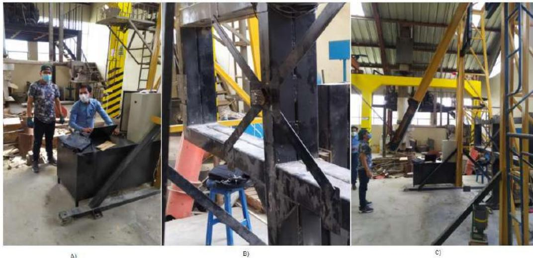
**Figura. 35-4:** A) Sistema de adquisición B) Sujeción de la probeta C) Elevación del péndulo
