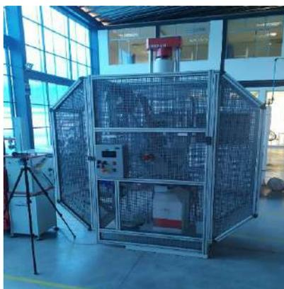
**Figura. 29-4:** Máquina de ensayos de Impacto Charpy
