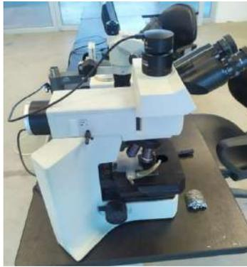
**Figura. 2-4:** Microscopio metalográfico OLYMPUS
