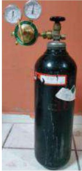
**Figura. 6-3.** Tanque de argón
