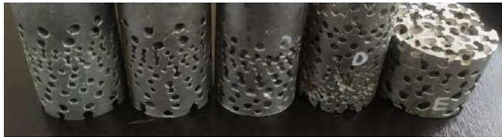
**Figura. 1-4:** Probetas fabricadas por el método de infiltración
