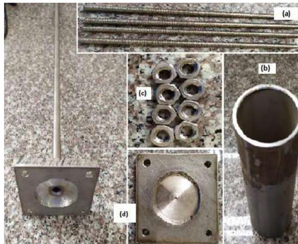
**Figura. 11-3:** Molde cilíndrico
