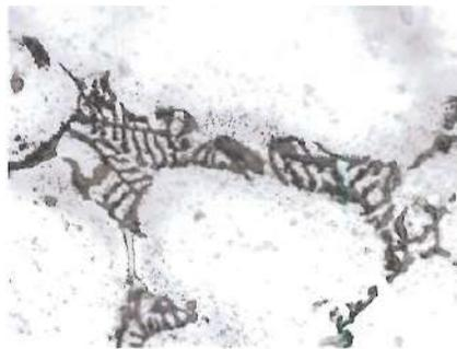
**Figura. 6-4:** Microestructura magnificada a 1000X, Ácido fluorhídrico, 15 seg
