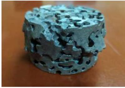
**Figura. 37-4:** Probetas posterior al ensayo de impacto dinámico
