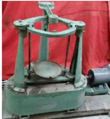
**Figura. 9-3:** Agitador mecánico de tamices
