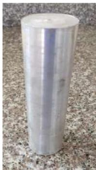
**Figura. 12-3:** Tocho de aluminio mecanizado
