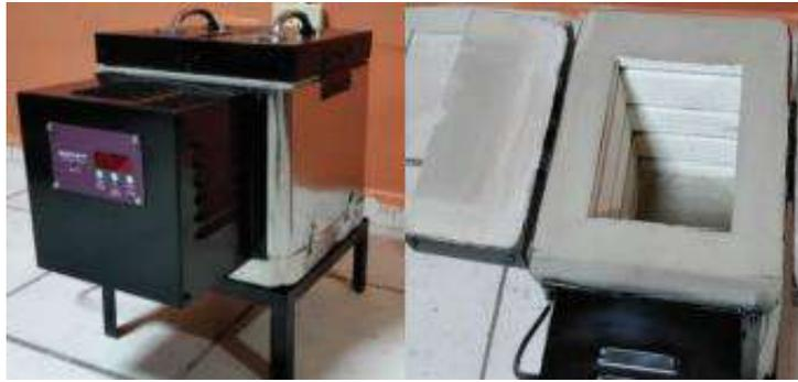
**Figura. 4-3:** Horno mufla eléctrico
