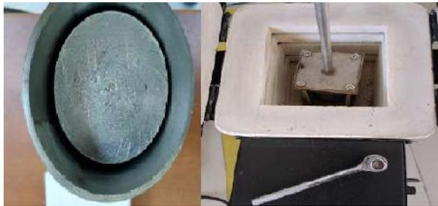
**Figura. 16-3:** Molde totalmente hermetizado
