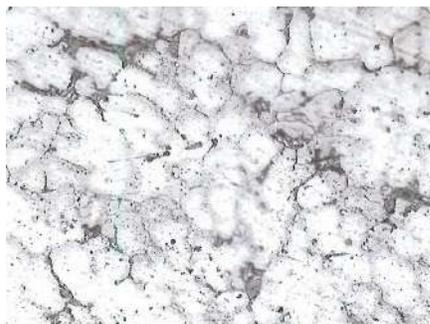
**Figura. 4-4:** Microestructura magnificada a 200X, Ácido fluorhídrico, 15 seg
