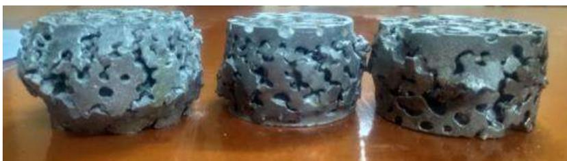
**Figura. 45-4:** Espumas de aluminio posterior al ensayo de compresión e impacto
