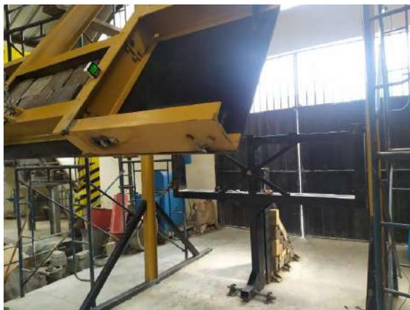
**Figura. 31-4:** Máquina de ensayo dinámico de impacto
