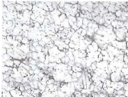
**Figura. 3-4:** Microestructura magnificada 100X, Ácido fluorhídrico, 15 seg
