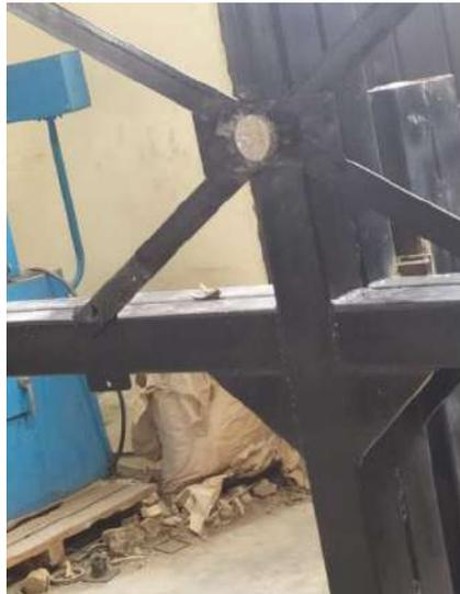
**Figura. 33-4:** ensamble del acople a la máquina de impacto dinámico
