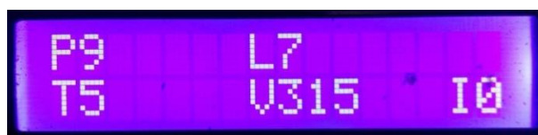
Gambar 6 Tampilan sampel LCD untuk nilai volume 315 cm 3
