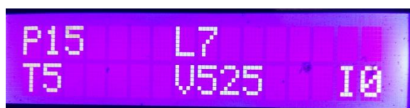
Gambar 8 Tampilan sampel LCD untuk nilai volume 525 cm^3
