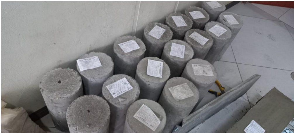
Ilustración 17 Muestra de probetas con dosificaciones distintas
