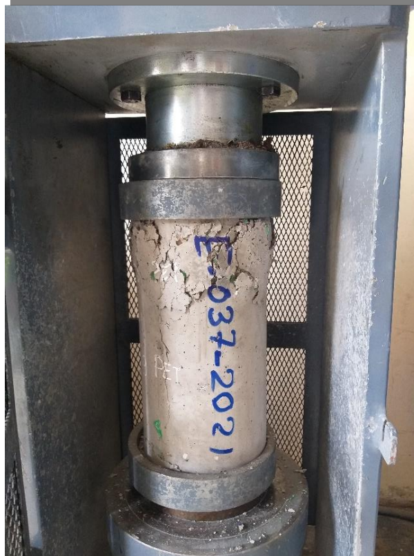
Probeta de Ensayo en proceso de ruptura
