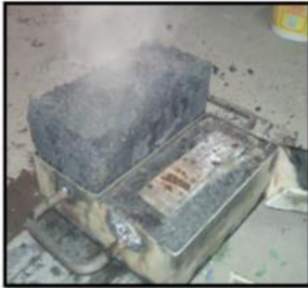
Ilustración 6 Molde de ladrillo PET
