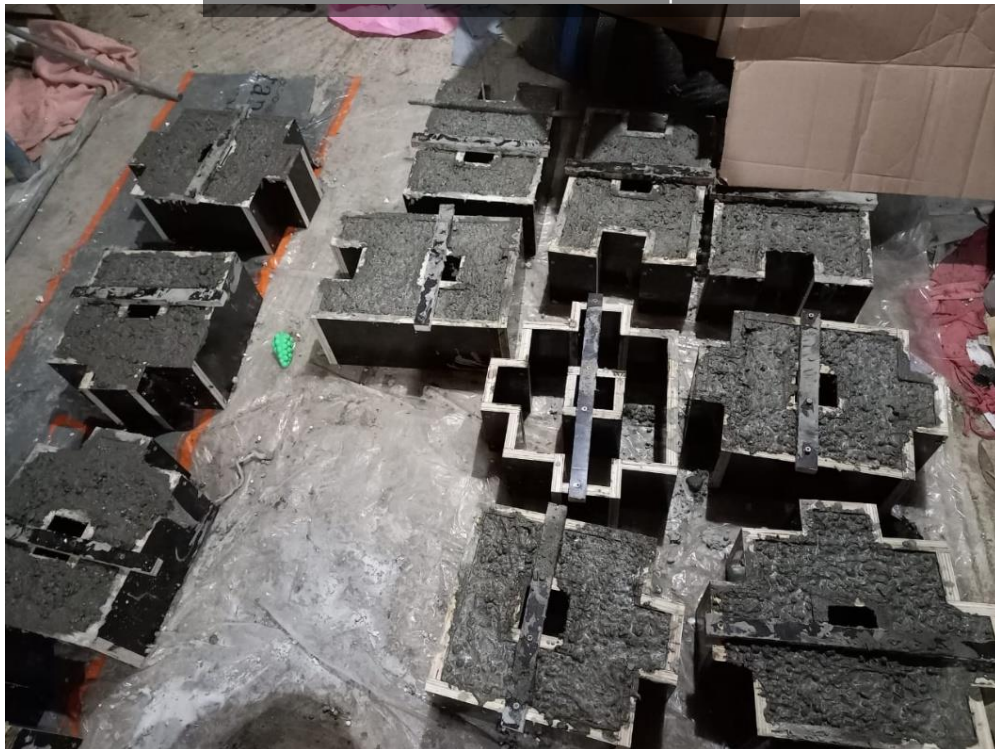
Reposo de mezcla en los moldes
