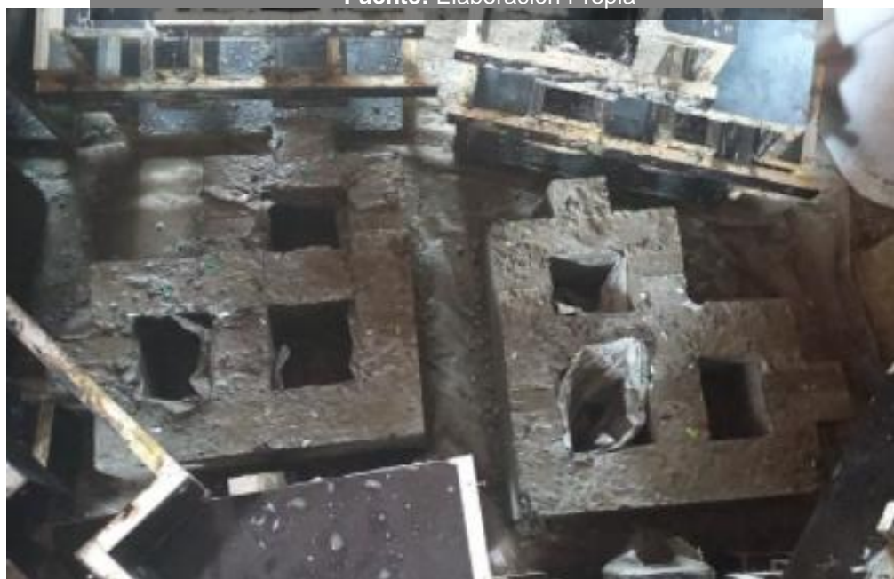
Desmoldar los ladrillos y proceso de secado
