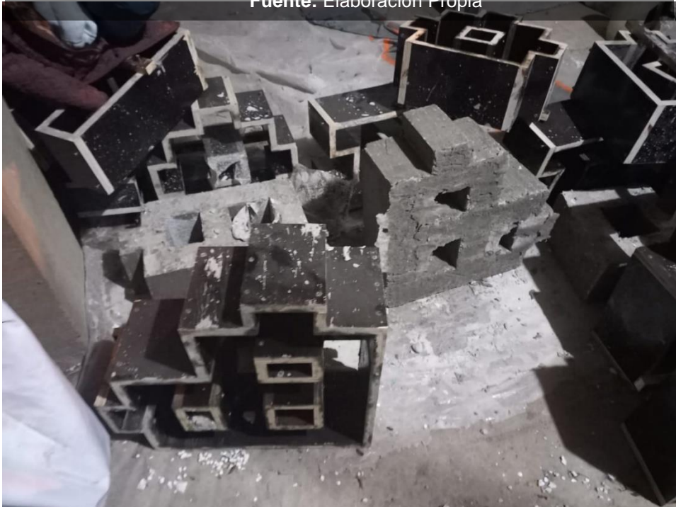
Desmoldar los ladrillos y proceso de secado
