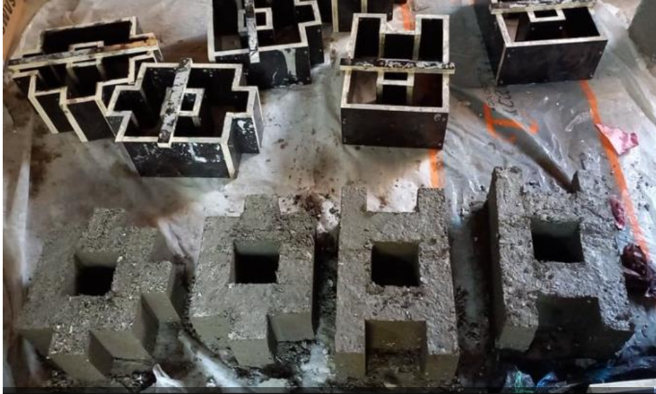
Desmoldar los ladrillos y proceso de secado
