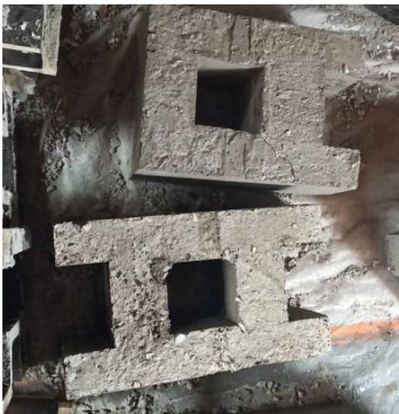
Desmoldar los ladrillos y proceso de secado
