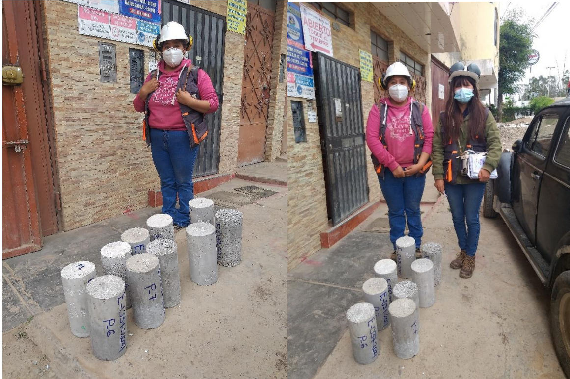
Ilustración 18 Probetas con 0% de dosificación de PET reciclado
