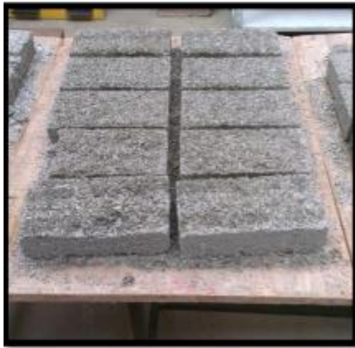
Ilustración 11 Ladrillos de PET con 25% de adición PET
