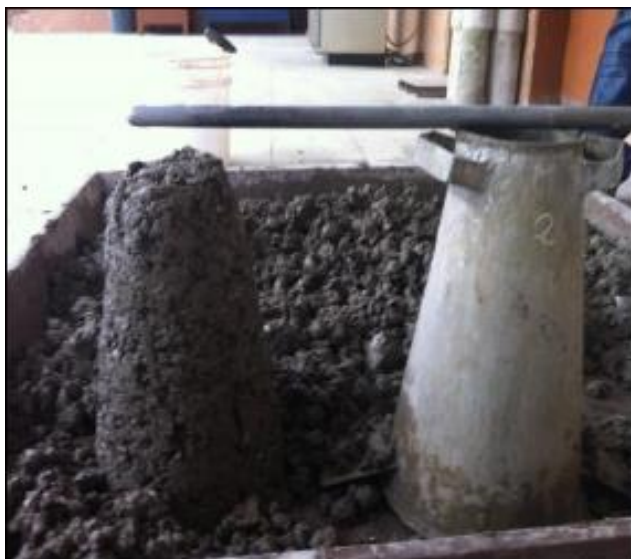
Ilustración 8 Ensayo de trabajabilidad con PET
