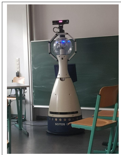
Abbildung 1.2: Roboter „Anna Constantia“ - eine mobile Plattform vom Typ Scitos G5 hergestellt von MetraLabs
