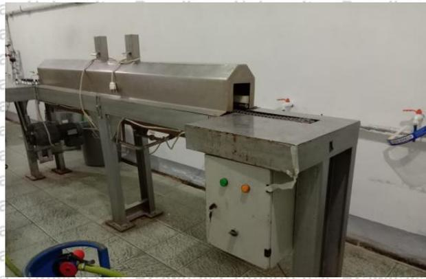
**Gambar 4.6.** Mesin *exhausting*
