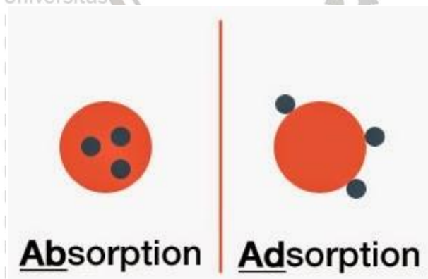
Gambar 2.9 Perbedaan absorpsi dengan adsorpsi Sumber: Syahida (2010)
