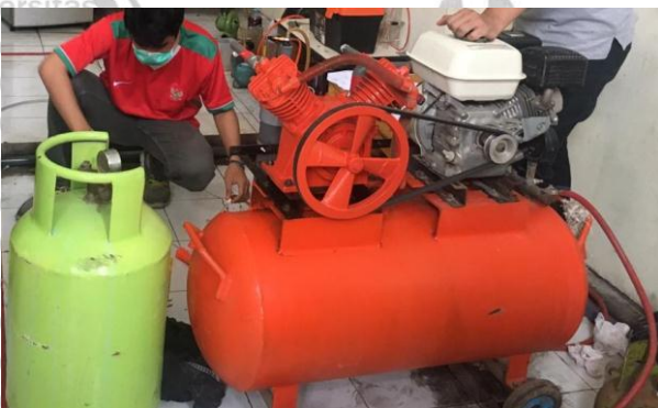
Gambar 3.7 Kompresor dan tabung biogas
