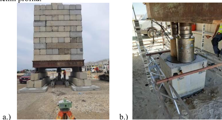
Slika 5. a.)Konstrukcija za odupiranje Kontra teret –balast b.)položaj hidraulične prese u toku ispitivanja Figure 5. a.) Resistance construction Counter load - ballast b.) position of hydraulic press during testing
