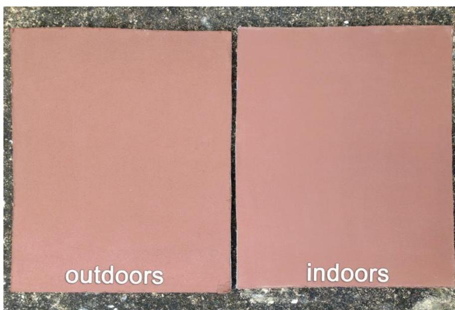
Figura 30: Variação colorimétrica das placas sujeitas ao teste de durabilidade após 12 meses de exposição a ambiente externo. Fonte: GALVAO et al, 2018.
