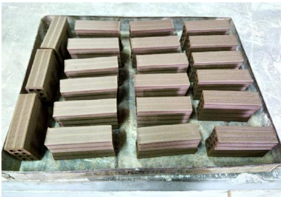
Por conta do alto teor de sílica no RBMF utilizado, a plasticidade do material final foi obtida por meio das argilas, que apresentaram índice de plasticidade de 44% para a argila cinza e 35% para a argila amarela, onde os limites de Atterberg indicam plasticidade acima de 15%; os limites líquidos encontrados foram de 60% e 56%, respectivamente, de acordo com a literatura encontrada pelos autores, entre 30% e 60%, sendo assim adequadas para produção de cerâmica.
