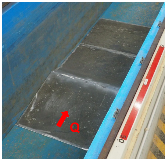
Bild 31: Einbau der Modelldüne (FloodSF) in der Umlaufrinne
