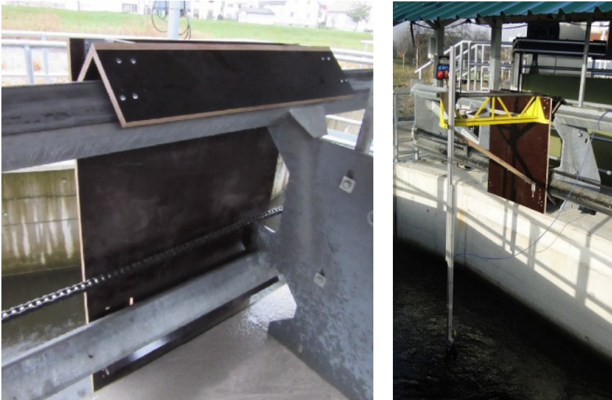
Abb. 66: Links für das Rechenschienensystem in Ottenau entworfener Messwagen auf der Rechenführung aufliegend und rechts in der Seitenansicht mit Aluschienen, an welchen das Messgerät befestigt war ( Quelle rechts: Schwab, 2016 ).
