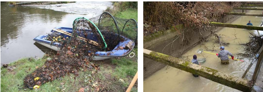
Abb. 92: Links: Hoher Treibgutanteil in einer Reuse nach einem Hochwasser ( Quelle: Engler et al., 2014 ). Rechts: aufwändige Elektrofischung im Kraftwerkskanal des WKW Ohrnberg in trübem und schlammigem Wasser mit Geschwemmsel, Ästen, schlechten Zugangsmöglichkeiten und baulichen Zwängen (Zugstreben des Kanals).
