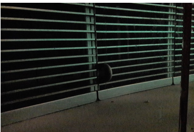
Abb. 146: Links: Versuch-Nr. V19.3 mit einem Aal, der sich zwischen die Rechenstäbe gewunden hat und so über die gesamte Versuchsdauer verharrete. Er ist mit seiner Position bei Schrägrechen an Wasserkraftanlagen durch den Rechenreinigungsarm gefährdet, der ihn wahrscheinlich verletzen oder töten würde. Rechts: Versuch-Nr. V24.2 mit einem Aal, welcher an den Schrägrechen angedrückt wurde. Er löste sich jedoch nach 4 Minuten und wanderte entlang der Rechenebene über den Bypass ab.
