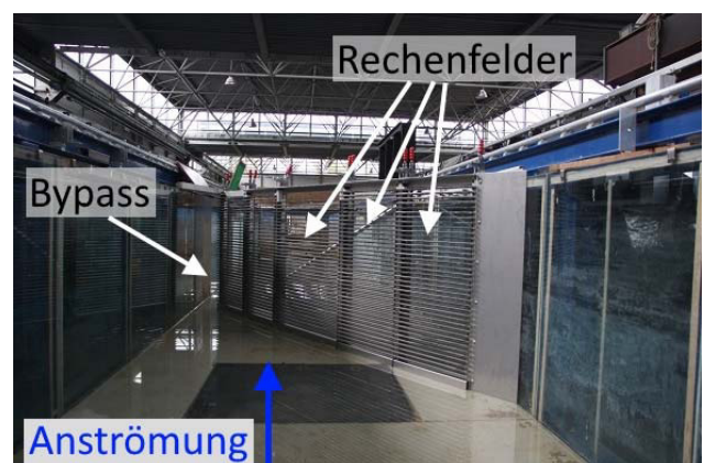
Abb. 44: Systemskizze des modularen Rechensystems für die Laborrinne (links) mit einem Anströmwinkel von 30^\circ (Quelle: Steinhardt, 2015). Ansicht des eingebauten Schrägrechens mit einem Anströmwinkel von 30^\circ mit Blick in Fließrichtung (rechts).
