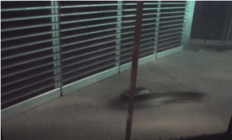
Abb. 158: Umkehrbewegung vor einer Berührung mit dem Rechen eines Aals bei Versuch-Nr. V15.1.
