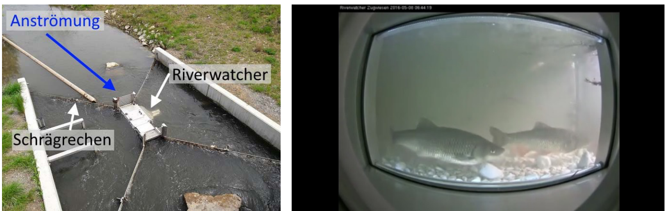
Abb. 90: Riverwatcher im eingebauten Zustand in den Zugwiesen Ludwigsburg (links) und in Betrieb zur Aufnahme der wandernden Fische (rechts) (Quelle rechts: Württembergischer Anglerverein e.V., 2017).
