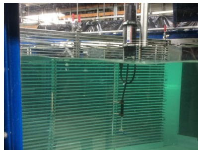
Abb. 54: Links Empfängeranordnung des Nortek Vectrino und die Ausrichtung des Koordinatensystems (Quelle: BAW verändert nach Nortek, 2014). Rechts Nortek Vectrino im Einsatz vor dem Schrägrechen im Forschungslabor (Quelle: Schwab, 2016).
