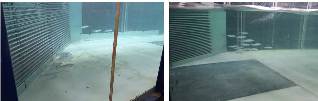
Abb. 125: Sohnlah orientierte Lachssmolts (links) bei Versuch-Nr. V13.2 und über 2/3 der Wassertiefe aufgereichte Lachssmolts (rechts) bei Versuch-Nr. V22.2.
