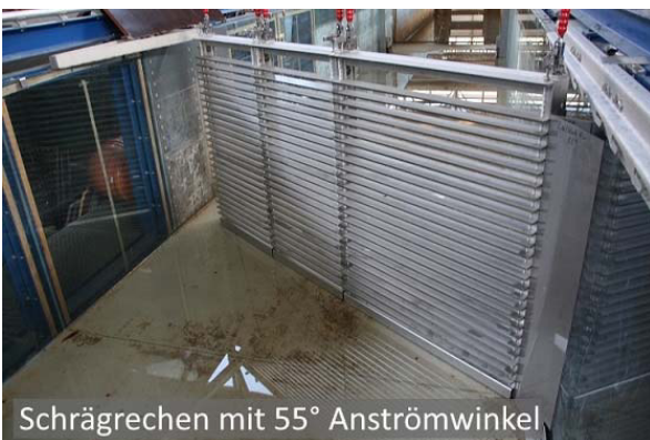
Abb. 95: Verschiedene Anströmwinkel mittels modularem Rechensystem im Forschungslabor der TU Darmstadt.
