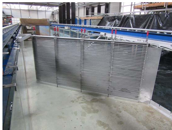
Abb. 26: Links Rechenfelder des Schrägrechens am WKW Ottenau mit Blick auf die uw-seitige Rechenebene (Quelle: EnBW, 2012). Rechts Rechenfelder des Schrägrechens im wasserbaulichen Forschungslabor.
