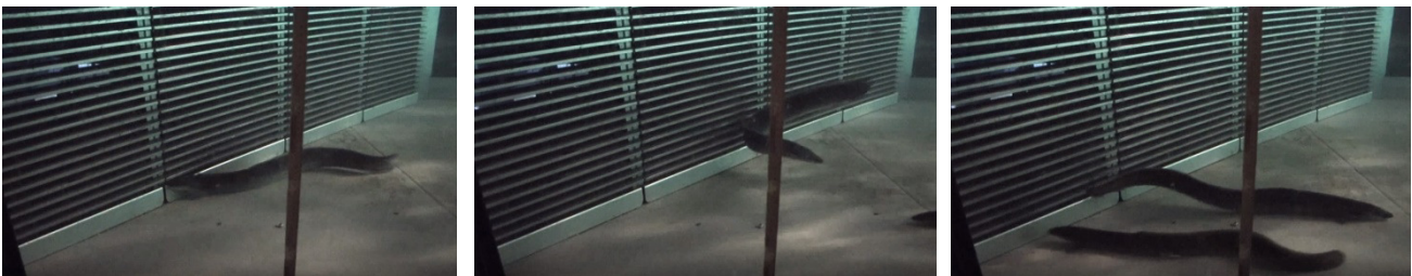
Abb. 148: Umkehrreaktion eines Aales bei Versuchs Nr. V1.4: Auftreffen auf den Schrägrechen mit dem Kopf nach einer aktiven Abwanderung (links), Umdrehen mit dem Körper (Mitte) und Kopf voran stromaufwärts schwimmend (rechts). Auf dem rechten Bild ist ein zweiter Aal unten sichtbar, welcher ebenfalls in einer aktiven Abwanderung kurz vor der Kollision mit dem Schrägrechen stand.
