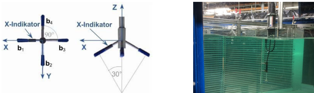
Abb. 54: Links Empfängeranordnung des Nortek Vectrino und die Ausrichtung des Koordinatensystems (Quelle: BAW verändert nach Nortek, 2014). Rechts Nortek Vectrino im Einsatz vor dem Schrägrechen im Forschungslabor (Quelle: Schwab, 2016).
