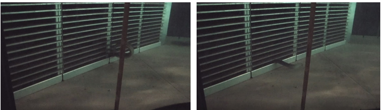
Abb. 156: Aale bei der Rechenpassage im Versuch-Nr. V13.1 (links und rechts). Beide Aale trafen mit dem Kopf voraus auf den Schrägrechen und gingen direkt in einen Stabzwischenraum hinein ohne vorheriges Abtasten und Sondieren.
