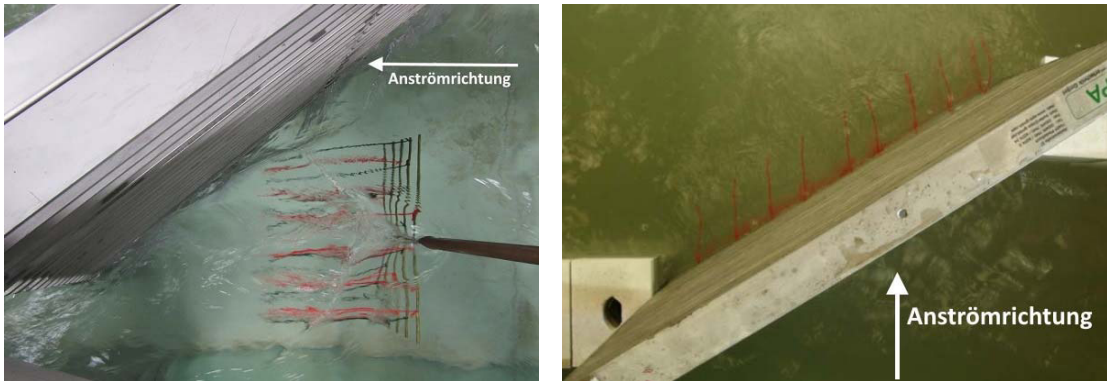
Abb. 12: Fadenharfe am Schrägrechen im Labor der TU Darmstadt (links) und unterwasserseitige Wollfäden am Schrägrechen im Labor des KIT (Quelle rechts: Nestmann, 2010).
