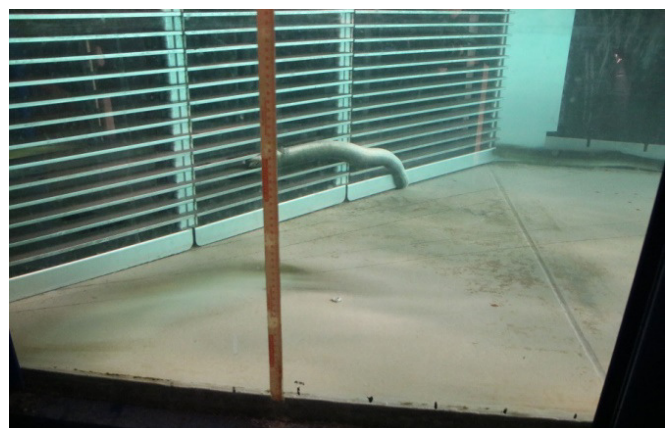
Abb. 146: Links: Versuch-Nr. V19.3 mit einem Aal, der sich zwischen die Rechenstäbe gewunden hat und so über die gesamte Versuchsdauer verharrete. Er ist mit seiner Position bei Schrägrechen an Wasserkraftanlagen durch den Rechenreinigungsarm gefährdet, der ihn wahrscheinlich verletzen oder töten würde. Rechts: Versuch-Nr. V24.2 mit einem Aal, welcher an den Schrägrechen angedrückt wurde. Er löste sich jedoch nach 4 Minuten und wanderte entlang der Rechenebene über den Bypass ab.
