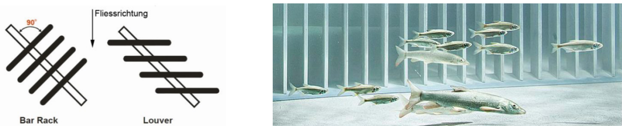
Abb. 18: Links Schemaskizze der Anordnung von Louver und Bar Rack (Quelle: Kriewitz-Byun, 2014). Rechts sohlnaher Ausschnitt eines Louvers in der Versuchsrinne bei ethohydraulischen Versuchen (Quelle: VAW, ETH Zürich, 2017).
