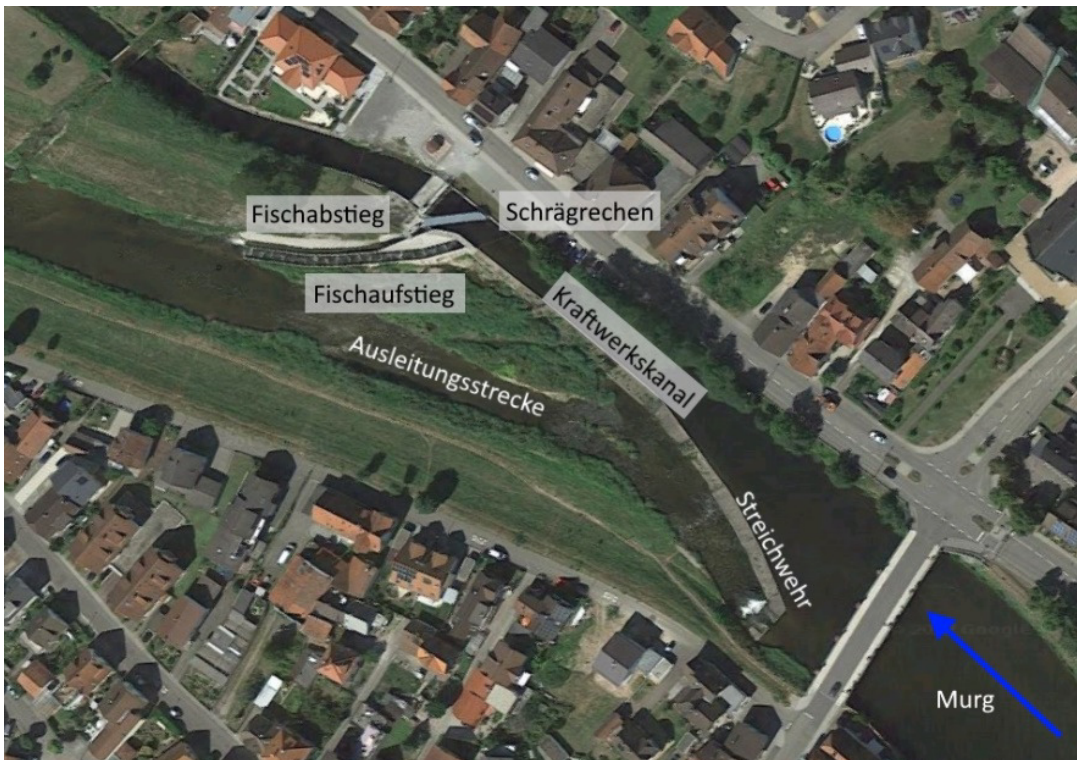
Abb. 64: Einlaufbereich zum Kraftwerkskanal mit dem 18mm-Schrägrechen in Ottenau (Quelle: verändert nach Google.maps).
