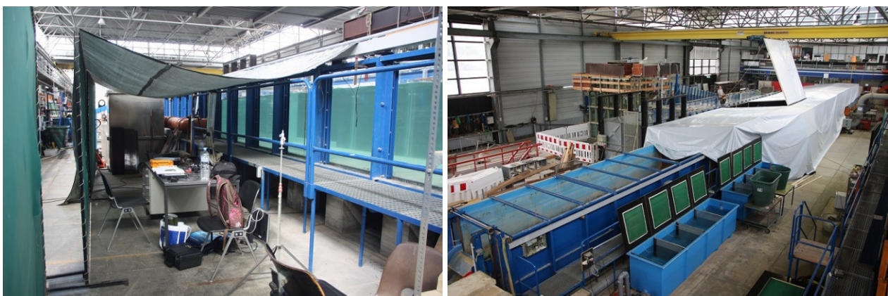
Abb. 85: Links Beobachtungsstand neben der Versuchsrinne und rechts Versuchsrinne mit Abdunkelung (Montageöffnung für den Umbau des Schrägwehres auf Foto geöffnet).
