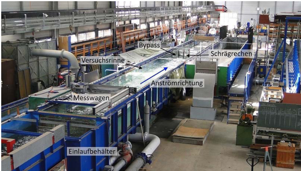
Abb. 43: Übersichtsbild der Versuchsrinne im wasserbaulichen Forschungslabor der TU Darmstadt mit dem Messwagen für die hydro-metrischen Aufnahmen (in Ruheposition).
