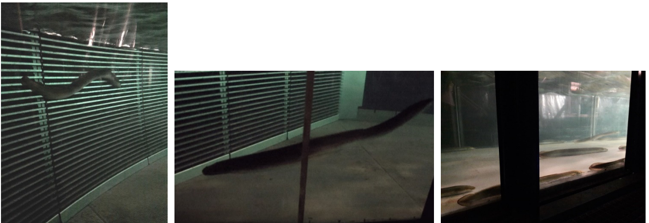
Abb. 159: Aale mit Kontakten zum Rechen nahezu an der Wasseroberfläche bei Versuch-Nr. V12.1 (links), direkt vor der Plexiglas-scheibe der linken Rinnenwand während der aktiven Abwanderung Richtung Bypass im Versuch-Nr. V6.2 (Mitte) sowie während der Abwanderung in der Versuchsrinne an der Sohle bei Versuch-Nr. V10.1 (rechts).
