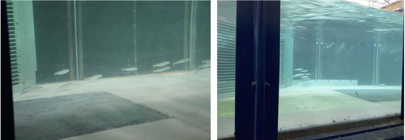
Abb. 98: Verharren von Lachssmolts an rechter Rinnenwand im Setup V3.3 (links) und im Setup V9.4 (rechts).
