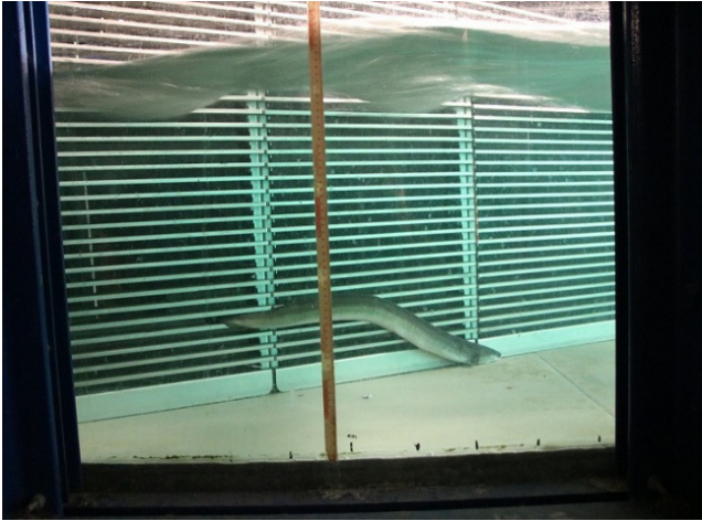
Abb. 145: Aal, welcher beim Rechensetup V9.1 ( 30^\circ/18\text{mm}/0,8\text{m/s} ) vom Impingement betroffen ist.
