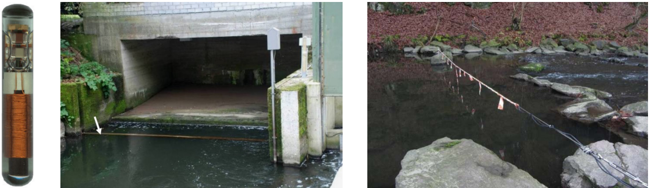
Abb. 91: Links: HDX-Transponder. Mitte: Rahmenantenne aus Holz. Rechts: Aufgespannte Antennen in einem relativ schmalen Gewässer. Quellen: Engler et al. (2014).
