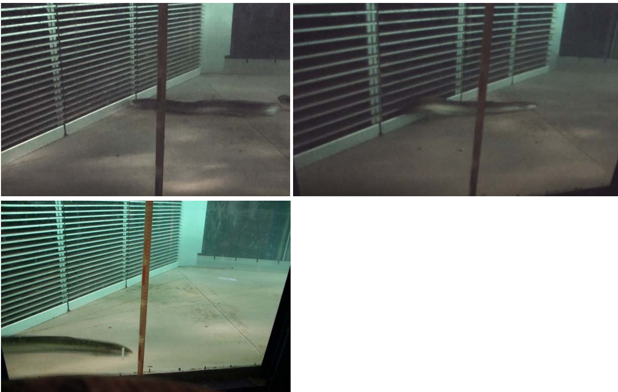
Abb. 154: Aal mit Kopf auf Rechen treffend im Versuch-Nr. V5.2 (links oben), den Zwischenraum der Rechenstäbe mit dem Schwanz abtastend im Versuch-Nr. V15.1 (oben rechts) und positiv rheotaktisch im Bereich des Bypasses ausgerichtet im Versuch-Nr. 5.3 (unten).
