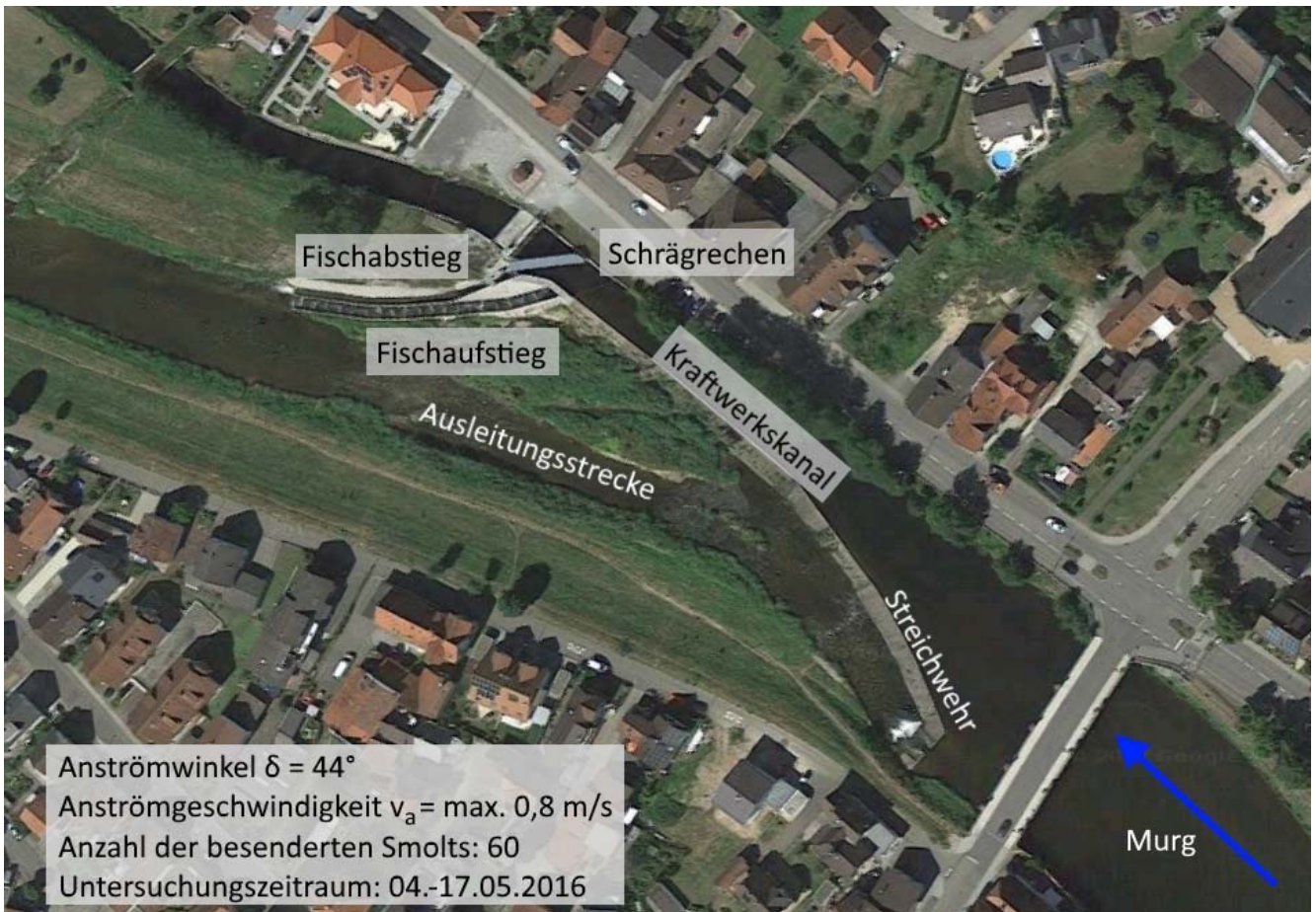
Abb. 126: Luftbild der Einlaufsituation in Ottenau mit Lage der Fischauf- und Fischabstiegsanlage sowie des Schrägrechens im Einlaufkanal des Kraftwerks Ottenau (Quelle: verändert nach Google.maps).
