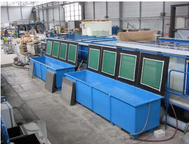
Abb. 79: Hälterung im wasserbaulichen Forschungslabor mit Frischwasserzuleitung und Belüftung.
