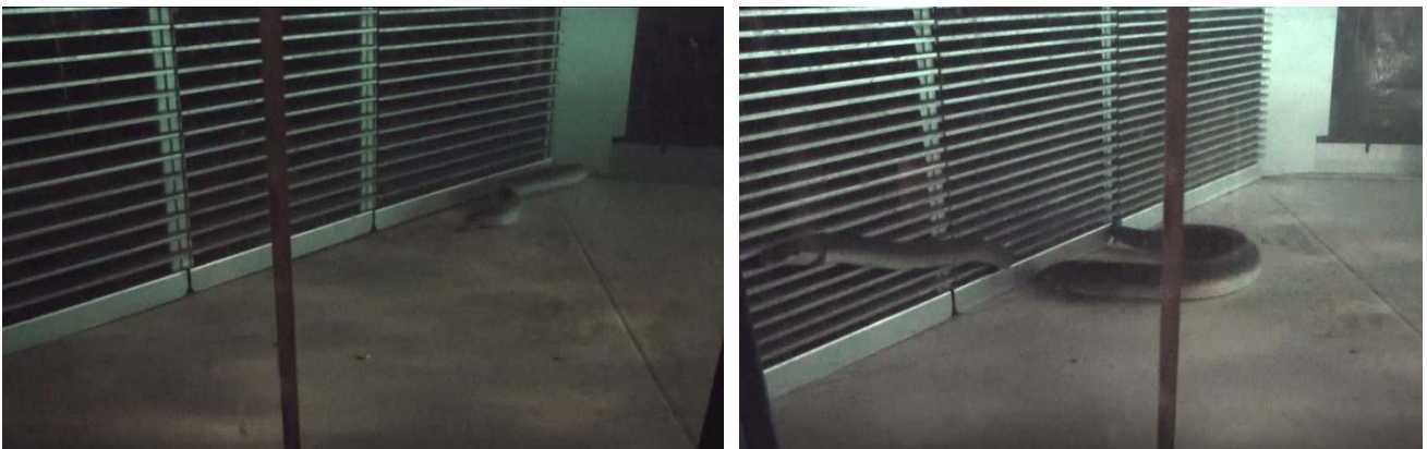
Abb. 151: Links Aal im Versuch-Nr. V21.1 kurz vor der Kollision mit dem Schrägrechen, seine Körperhaltung war angiloform ausgebildet, er driftete passiv auf den Rechen. Rechts Aal im Versuch-Nr. V5.1 im Augenblick der Kollision mit dem Schrägrechen, seine Körperhaltung war ebenfalls angiloform ausgebildet. Links neben dem Aal (rechte Abb.) verharrte ein Aal auf der Rechenebene.
