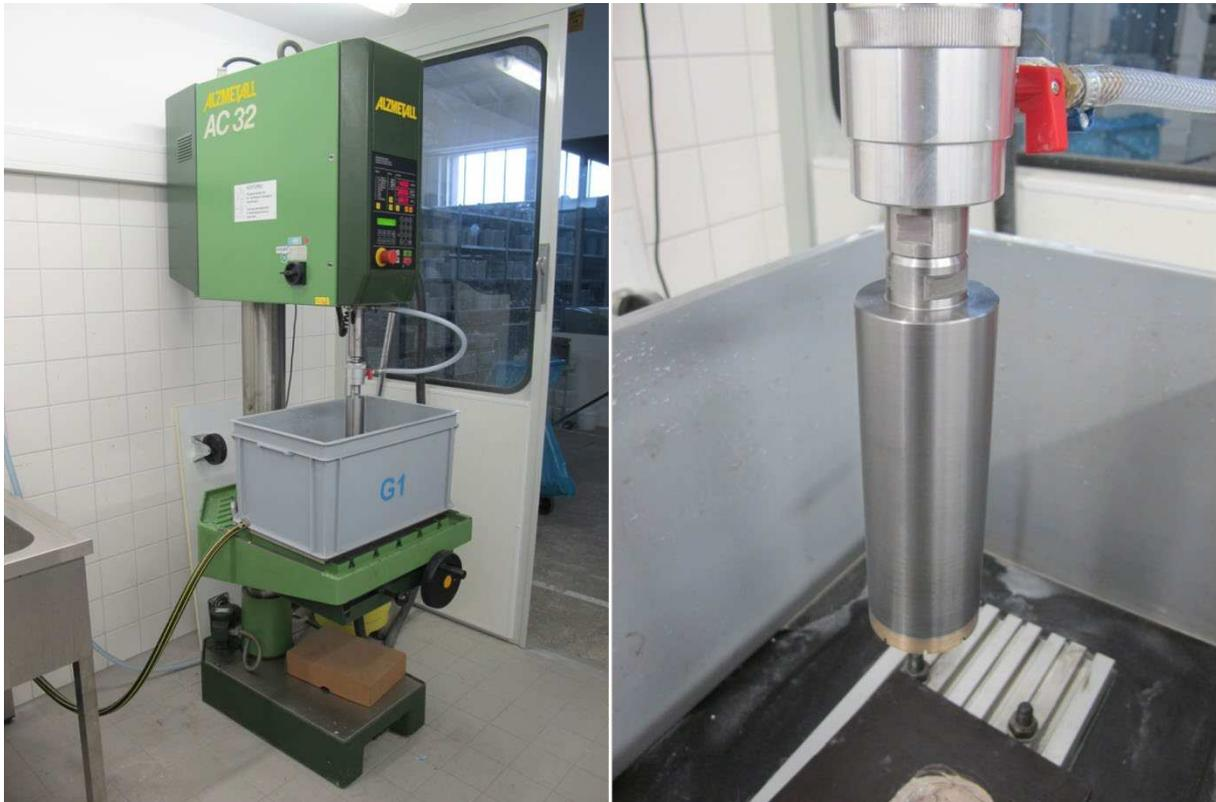
Abbildung 41: Ständerbohrmaschine und Diamantbohrkrone (Innendurchmesser 50,1 mm)
