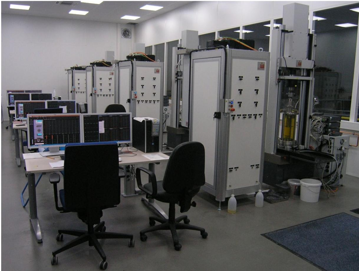
Abbildung 37: Triaxial-Prüfstände der BAW
