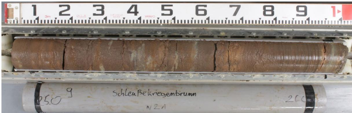
Abbildung 20: Kernfotografie des Kriegenbrunner Schluffsteins (Bohrung N21, Tiefe 25 bis 26 m)
