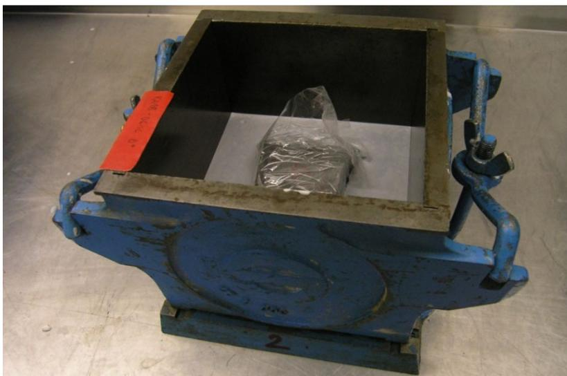
Abbildung 40: Eingegipste Probe in Würfelform
