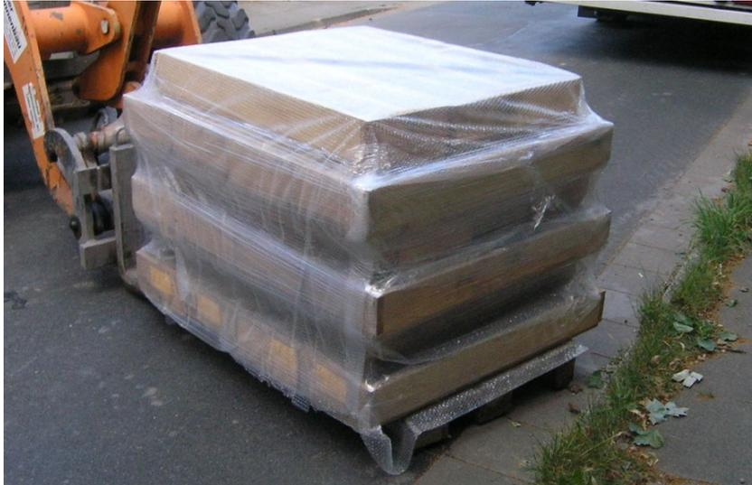
Abbildung 29: Mit Luftkissenfolie ummantelte Kernkisten
