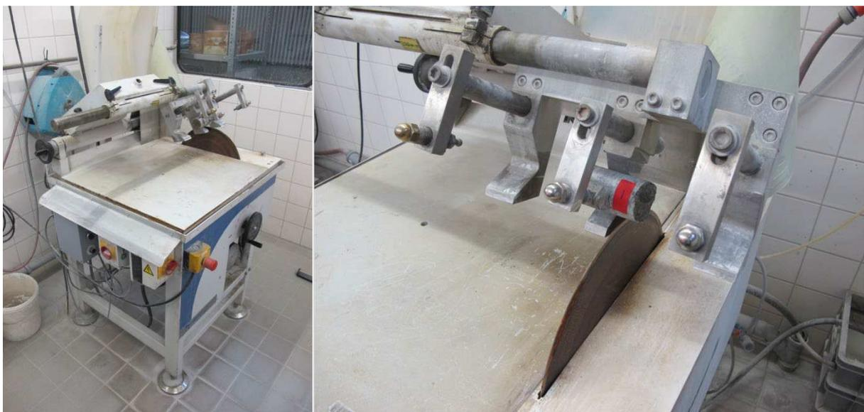
Abbildung 42: Diamantsäge mit eingespannter Probe
