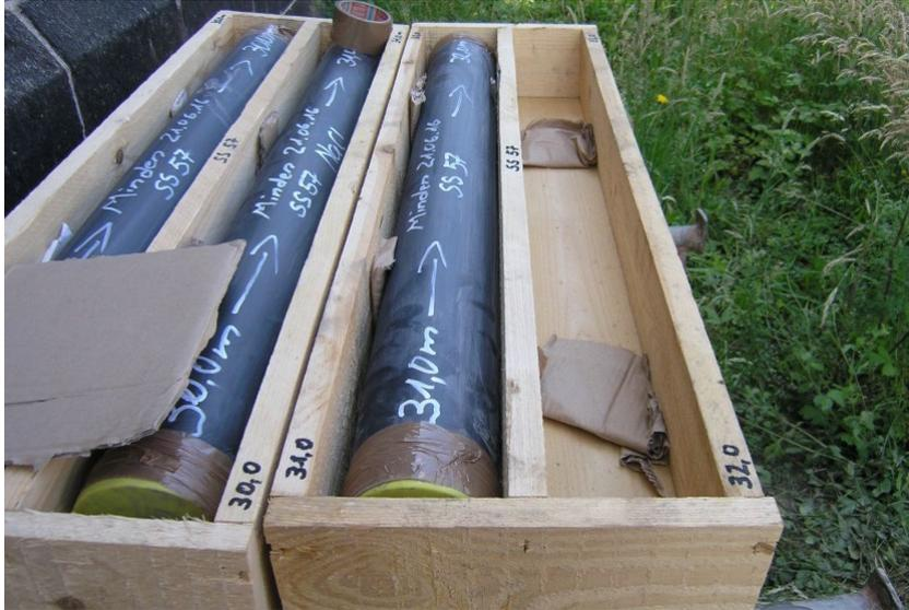
Abbildung 28: Pappstreifen zur Stabilisierung der Kerne in den Kisten während des Transports
