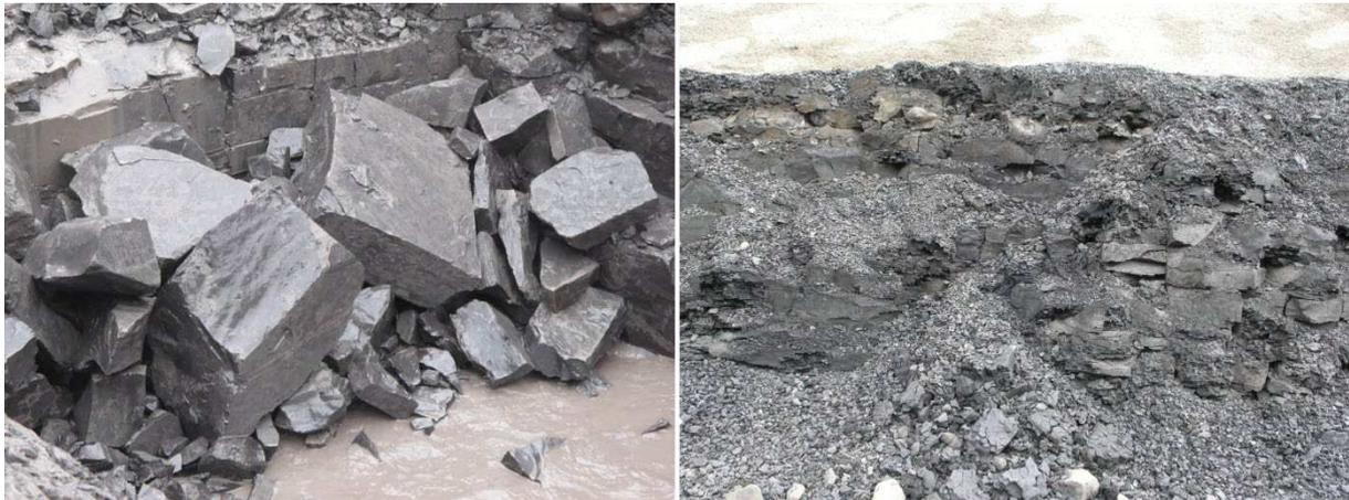
Abbildung 18: Mindener Tonstein im Aufschluss (links im frischen Anschnitt, rechts mit einsetzendem Zerfall)
