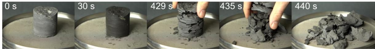
Abbildung 80: Zerfallsversuch an einer zylindrischen Tonsteinprobe
