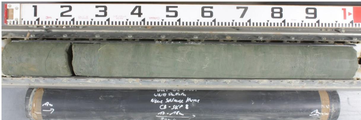
Abbildung 22: Kernfotografie des Emscher Mergels (Bohrung BKF-WE101, Tiefe 17 bis 18 m)
