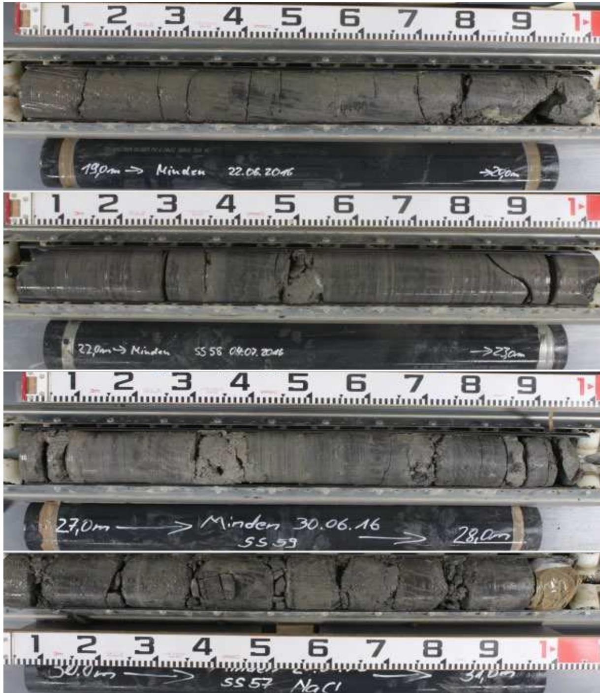
Abbildung 44: Bohrkern des Mindener Tonsteins aus unterschiedlichen Bohrungen und Tiefen
