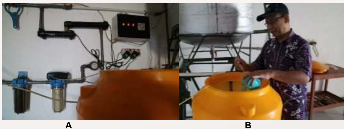
Gambar 3. Persiapan media produksi; A: perangkat sterilisasi UV lamp dan ozonisasi dan B: penuangan media produksi pada chamber media
