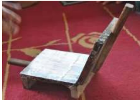
Gambar 1. Alat Cetak Opak tradisional “Jajaplok”
