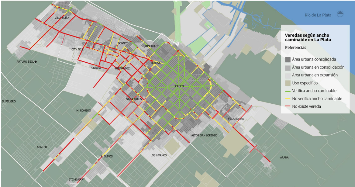
Figura 6. Verificación de veredas según ancho caminable para La Plata. Fuente: Elaboración de la autora (2019).
