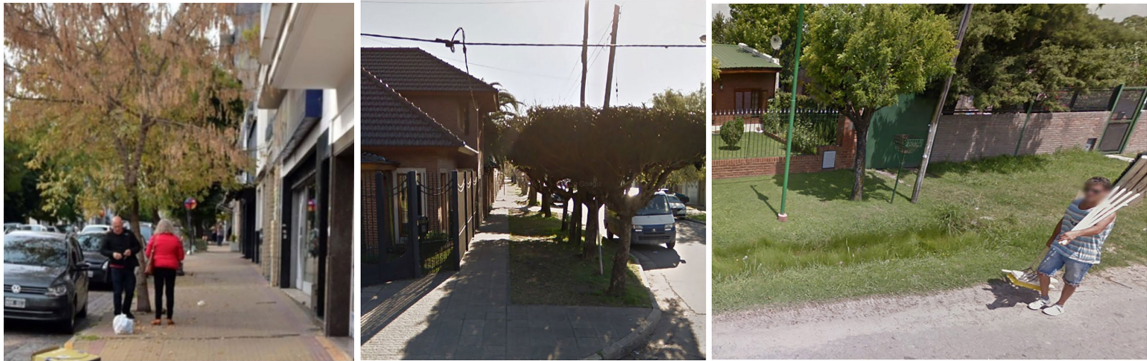
Figura 5. Izquierda: Vereda que verifica el ancho caminable. Centro: Vereda que no verifica el ancho caminable. Derecha: Espacio peatonal sin vereda. Fuente: Google Street View (2019).
