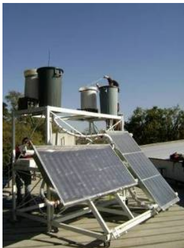
Banco de ensayos del calefón solar y esquema de sus componentes.
