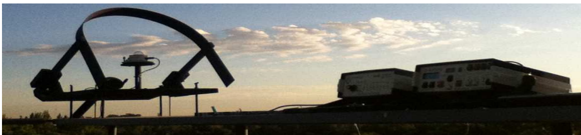
Fig. 1: Estación de medición de iluminación natural del Instituto de Ciencias Humanas Sociales y Ambientales (INCIHUSA)
