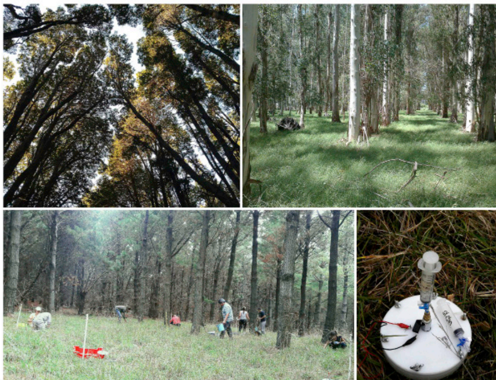
Figura 1. Ejemplo de medición de metano con cámara estática instalada en el suelo donde se toman muestras de aire de su interior, en intervalos regulares de tiempo, para analizar el cambio en la concentración de metano en la interfaz suelo-atmósfera.
