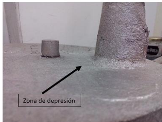
Figura 5: Análisis del rotor por zona boroscópica.
