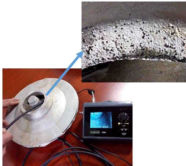
Figura 4: Análisis del rotor por zona boroscópica.
