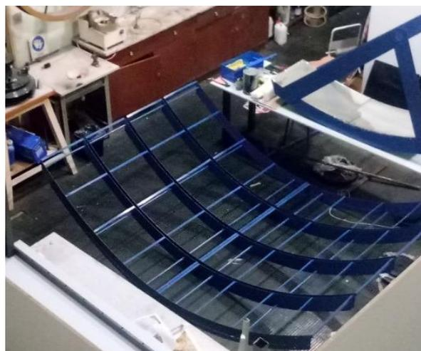
Figura 3. Estructura colectora
