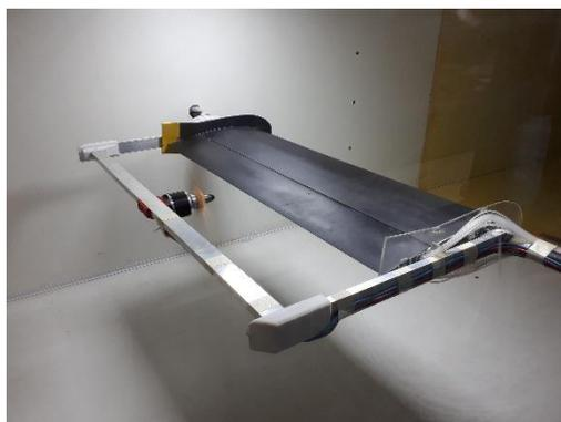
Figura 2: Modelo en túnel de viento.
