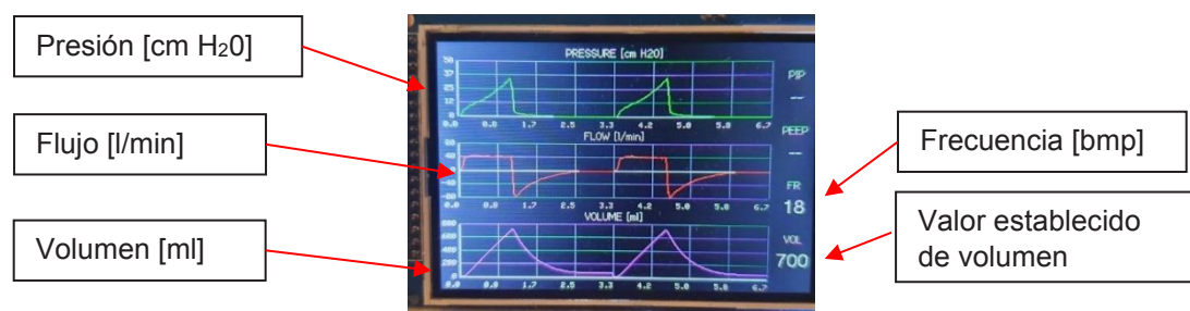
Figura 10 – Visualización de variables. Control a flujo constante.
