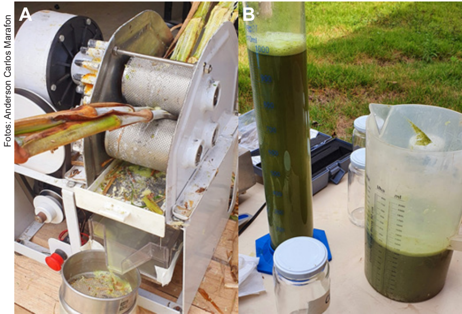
Figura 2. Extração do caldo dos colmos de capim-elefante: A - Moenda com rolos de aço inoxidável; e B - Caldo extraído. Rio Largo, AL, 2021.
