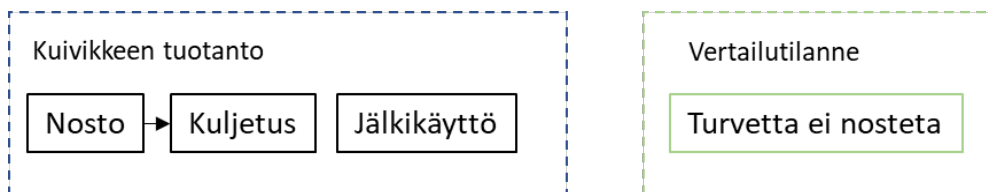
Kuva 4. Kuiviketurpeen tuotannon prosessikaavio ja vertailutilanne.
