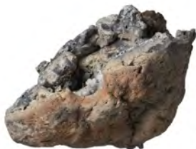
Fig. 20.1 Smeedhaardslak V368. Planoconvexe smeedhaardslak met duidelijk zichtbaar het gat van de tuyère.
