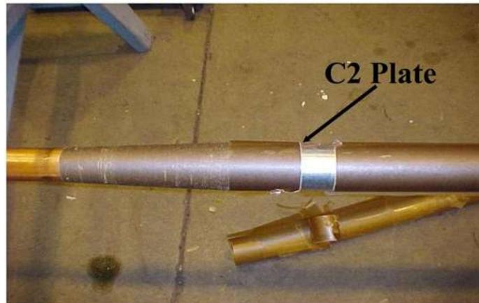
Gambar 2.9 Konduktor Bushing dilapisi Kertas Isolasi
