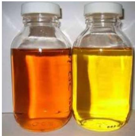
Gambar 2.15 Minyak Isolasi Trafo
