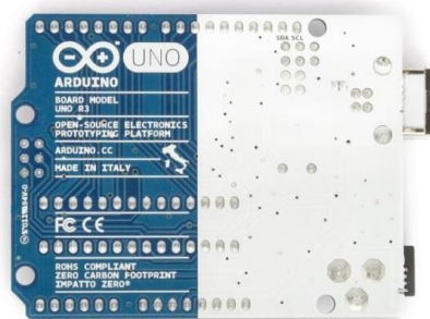
Gambar 2.9 Modul ATmega 328P Arduino UNO Tampak Belakang (Sumber: Dinata, Yuwoono Marta, 2015: 3)
