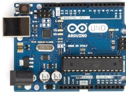
Gambar 2.8 Modul ATmega 328P Arduino UNO Tampak Depan (Sumber: Dinata, Yuwoono Marta, 2015: 3)
