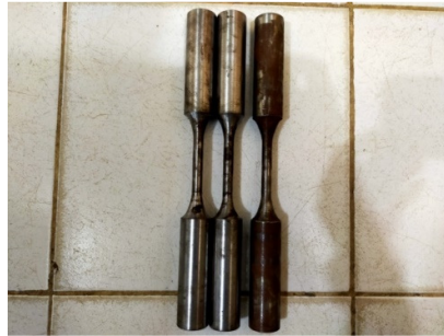
Gambar 3. Spesimen Uji Tarik
