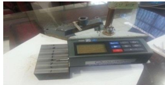
Gambar 6. Proses Pengujian Kekasaran Permukaan
