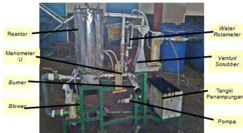
Gambar 2 : Alat Gasifikasi Sistem Updraft Double Gas Outlet
