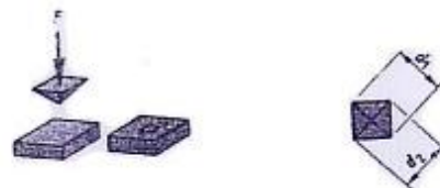
Gambar 6: Azas pengukuran kekerasan menurut Vickers
