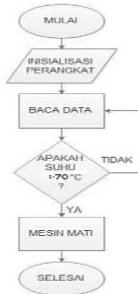
Gambar 4.7. Diagram Flowchart untuk Mendeteksi Suhu Pemotong Papan PCB
