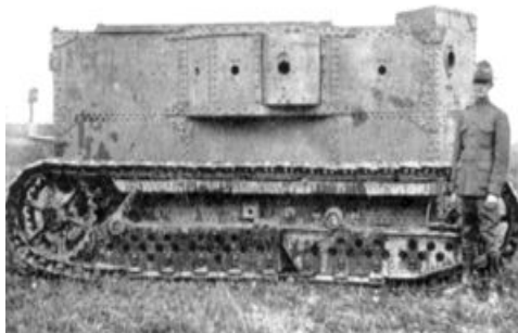
Slika 1. Nemački tenk sa električnim pogonom iz 1916. godine[1]
