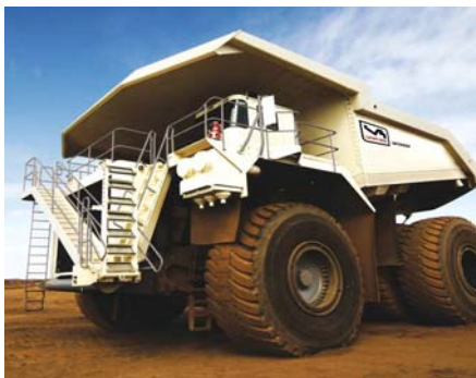
Slika 2. Unit Rig (Terrex&Co.), damper sa elektro pogonom [10]
