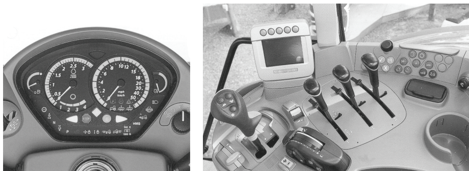
Sl.5. Kontrolno-upravljački uređaji u kabini savremenog traktora
