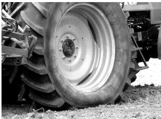
Sl. 3. Izgled deformacija pneumatika i tla pri kontaktu podloge i opterećenog točka traktora
