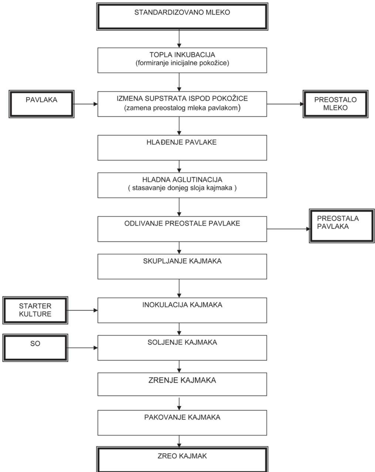
Šema 1. ŠEMATSKI PRIKAZ INDUSTRIJSKOG POSTUPKA PROIZVODNJE KAJMAKA Scheme 1. PROCEDURE OF THE KAJMAK PRODUCTION ON INDUSTRIAL SCALE
