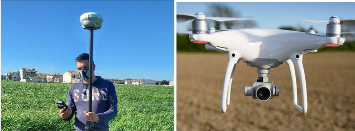
**Figura 13:** GPS SP60 e drone Phantom 4Pro utilizados no trabalho de campo.
