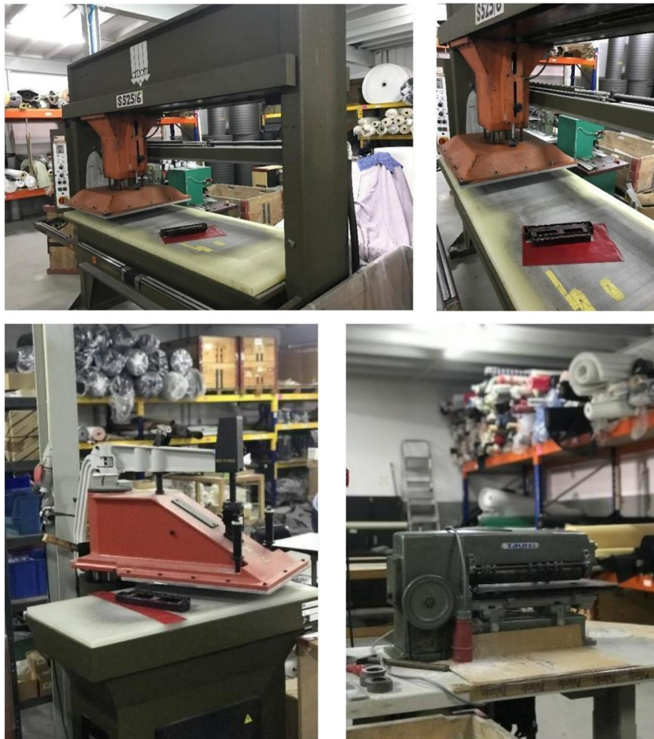
Figura 31 - Da esquerda para a direita: Balancé de ponta. Pormenor do molde e material. Balancé de braço. Máquina de corte linear. FONTE: Fátima COSTA
