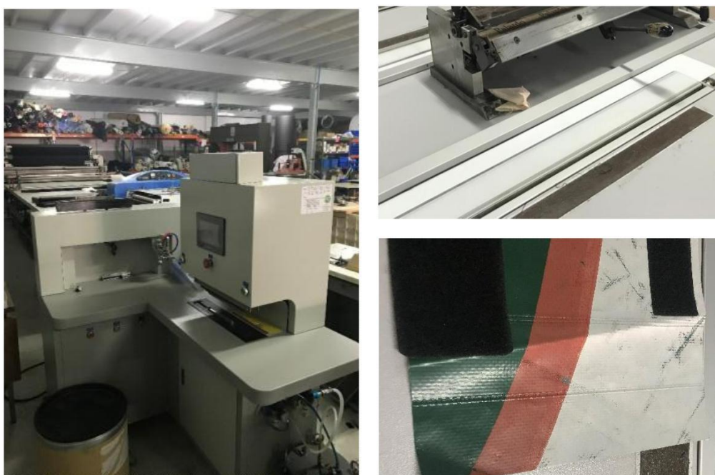
Figura 37 - De cima para baixo: Máquina de aplicar cola e dobrar janelas. Máquina de aquecer material para dobrar. Pormenor da marca depois do material (toldo) ser submetido à máquina de aquecer. FONTE: Fátima COSTA
