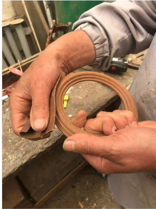
Figura 61 - Da esquerda para a direita: Parte 1. Desbaste da superfície da peça. FONTE: Fátima COSTA
