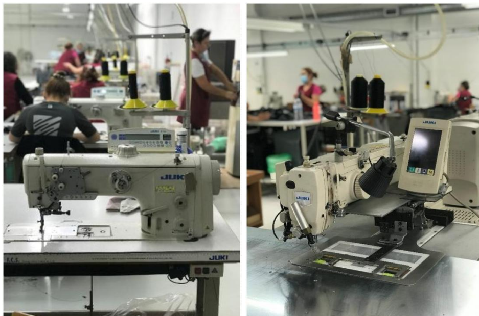
Figura 32 - Da esquerda para a direita: Máquina plana de triplo arrasto, de uma e duas agulhas. Máquina de costura automática (tipo cnc). FONTE: Fátima COSTA
