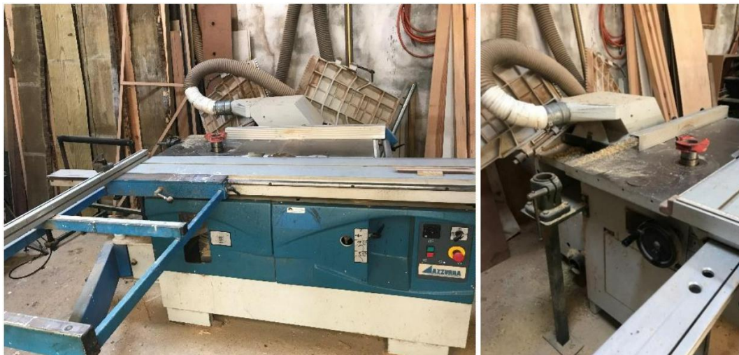
Figura 20 - Máquina universal/multifunções (disco, desengrosso e tupia). FONTE: Fátima COSTA.
