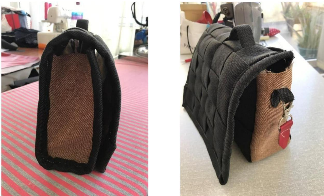
Figura 52 - Da esquerda para a direita: Teste da costura da lateral feita por fora. Teste da costura da lateral feita por dentro. FONTE: Fátima COSTA
