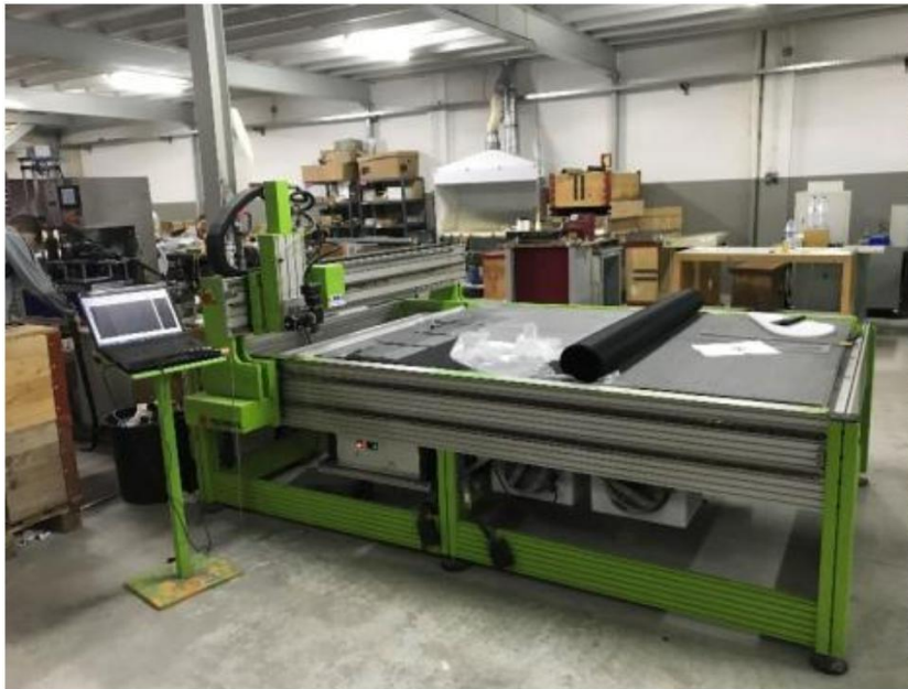
Figura 30 - CNC de corte com lâmina, a vácuo. FONTE: Fátima COSTA
