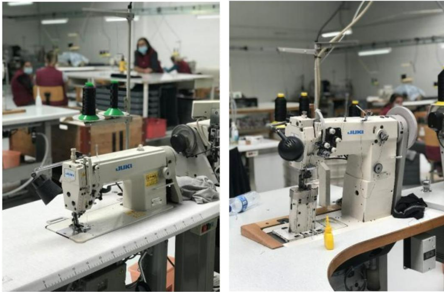
Figura 33 - Da esquerda para a direita: Ponto corrido com faca de aparar. Máquina de coluna, de duas agulhas. FONTE: Fátima COSTA
