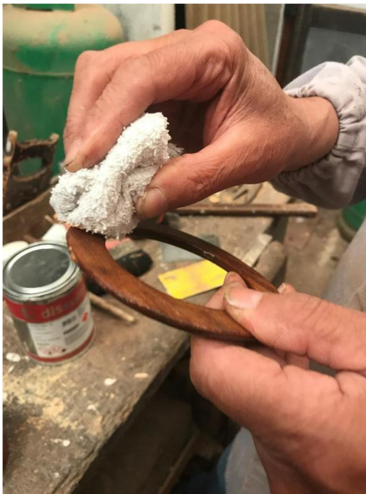
Figura 64 - Aplicação da cera na peça com o auxílio de um pano. FONTE: Fátima COSTA
