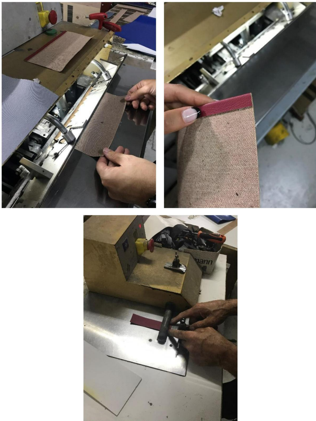
Figura 68 - De cima para baixo: Dobragem das bainhas com a máquina elétrica de fazer bainhas; Resultado da bainha feita; Dobragem das bainhas para as tiras. FONTE: Fátima COSTA
