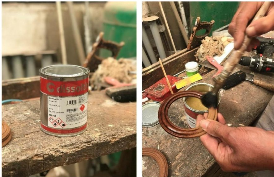
Figura 62 - Aplicação do tapa poros na peça. FONTE: Fátima COSTA
