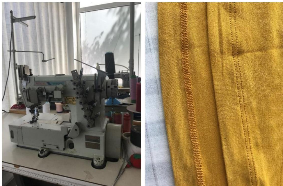
Figura 14 - Da esquerda para a direita: Máquina de recobrimento. Pormenor da técnica de recobrimento. FONTE: Fátima COSTA
