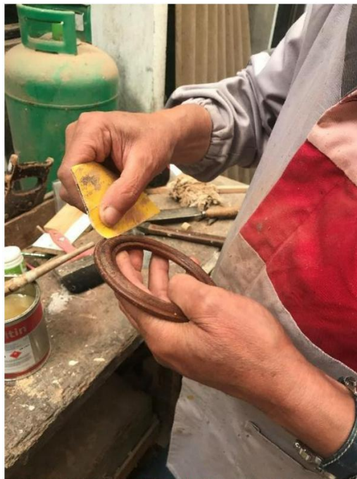
Figura 63 - O artesão desbasta a superfície da peça com uma lixa mais macia.
