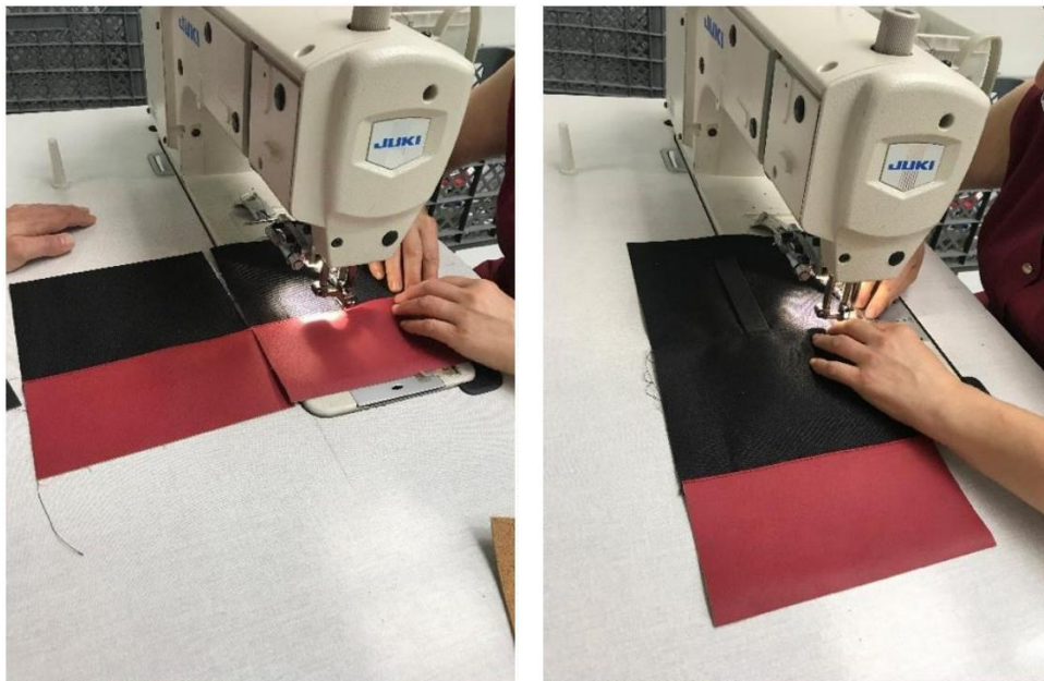
Figura 70 - Costura das tiras de pele com o tecido e forro. FONTE: Fátima COSTA
