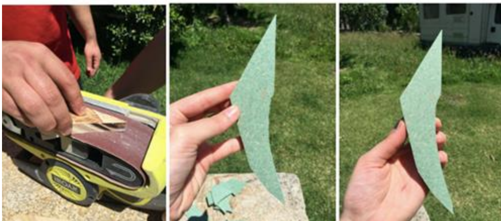
Figura 93- lixagem das peças após corte. Imagem do centro corresponde ao antes e imagem da direita corresponde ao após lixagem. Fonte: Autora.
