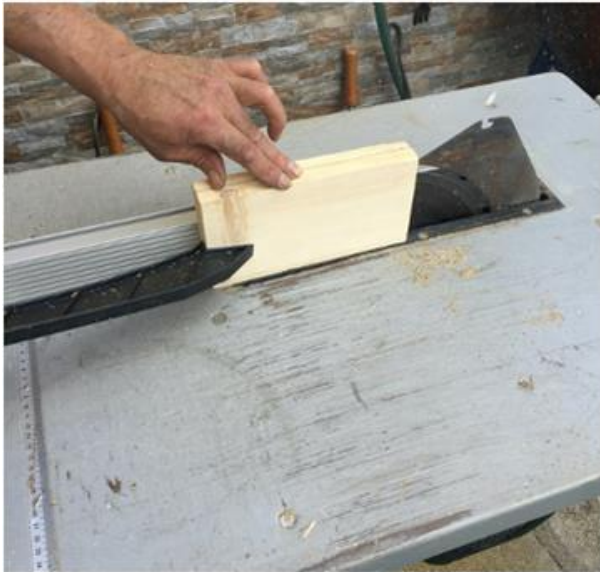
Figura 89- Corte de madeira com 1,5cm de espessura. Execução: Sr. Paulo na sua residência. Fonte: Autora.
