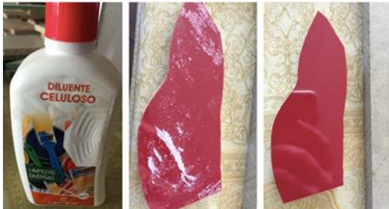
Figura 91- Remoção do papel e da cola com diluente, individualmente. Fonte: Autora.
