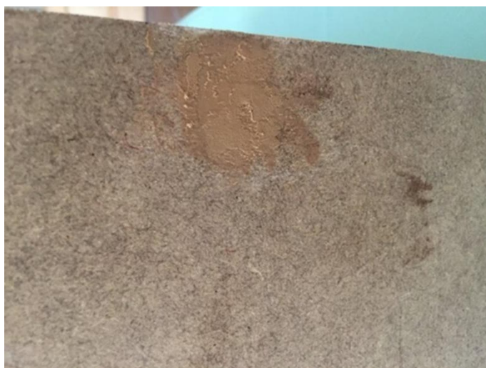
Figura 113- Inserção da pasta seladora de madeira sobre os parafusos, gaveta. Fonte: Autora.
