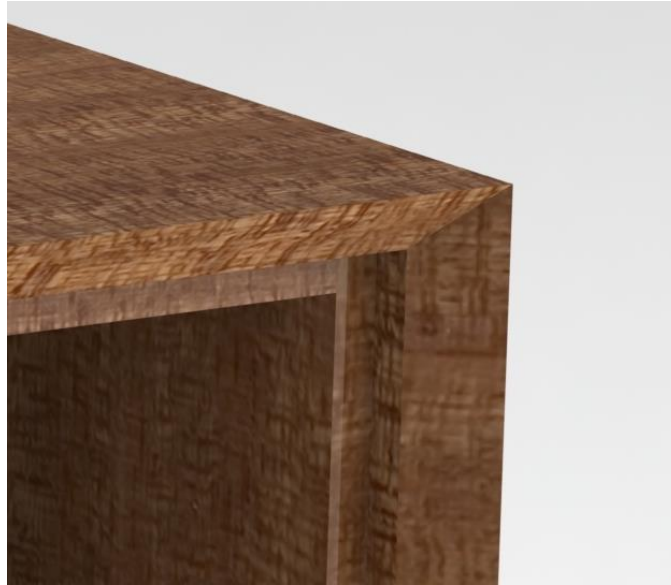
Figura 68 - Render do quanto superior direito do produto. Junção das partes lateral (ilhargas) e superior (tampo) a meia-esquadria. Modelação digital. Fonte: Autora.
