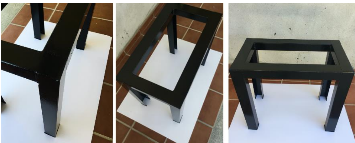
Figura 110- Pintura das pernas com pincel, e tinta preta para ferro, acabamento com verniz incolor. Fonte: Autora.
