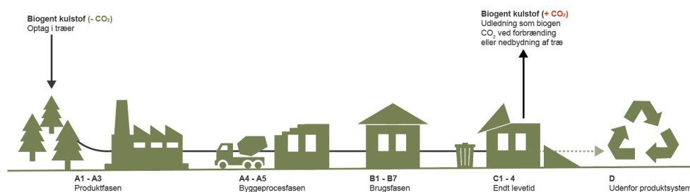
FIGUR 2. -1/+1 metode til beregning af biogent kulstof i træprodukter
