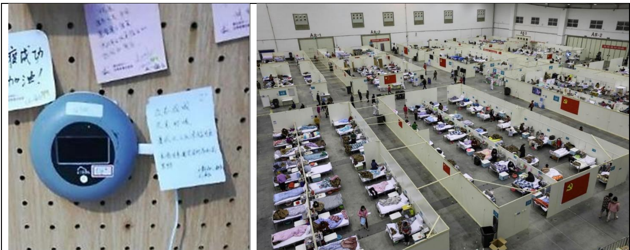
Figur 10. A) Mobil sensor for CO 2 , PM 2.5 masse koncentration, luft temperatur og relative fugtighed. B) plan over midlertidig hospital i Wuhan [68].
