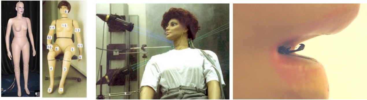
Fig. 12 Åndedræts termisk dukke: a) forskellig kropsholdning; b) Laser Doppler-målinger af grænselaget omkring kroppen; c) temperatur-, fugtigheds- og gasprøvetagningssensorer installeres i munden.
