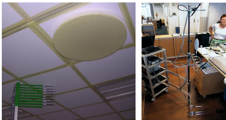
Fig. 10 Lavhastighedsanemometre med flere transducer anvendes til måling omkring lufttilførselsarmatur og b) under feltmålinger (4 hastigheds- og temperaturtransducere er fastgjort til armen på en vogn med forskellige måleinstrumenter).
