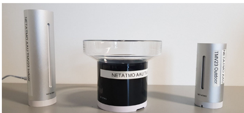
Figur 2 Indendørsmodul (venstre), regnmåler (midt) og udendørsmodul (højre).
